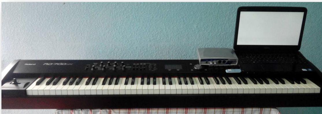
Ilustración 27. Medios utilizados en el presente modelo: Teclado digital, Interfaz de sonido (con conexión MIDI), computadora
