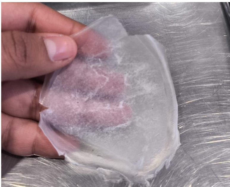
Figura 20. Biopelícula obtenida a partir de almidón de frijol negro con una concentración de 1.0 g
