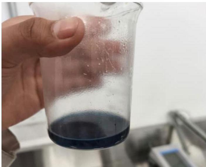
Figura 17. Prueba de Lugol realizado para la identificación de almidón en la extracción del frijol negro.
