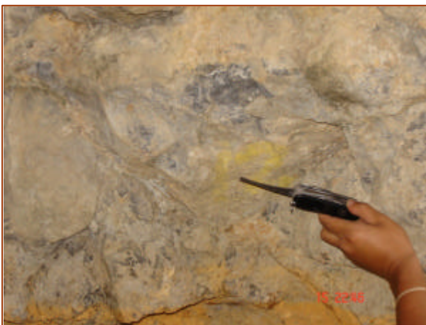
Figura 22 Se observan impregnaciones de Azufre dentro del túnel perforado en el área de “Anabella”.
