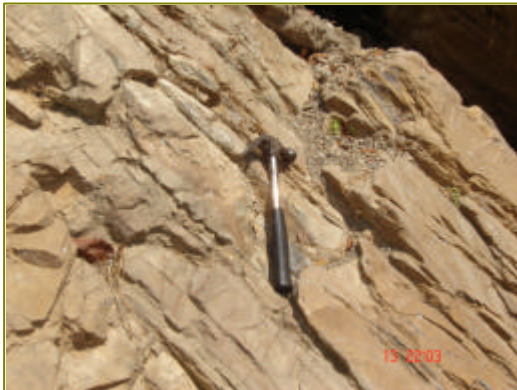
Figura 15 Tercer quebrada, esta no se apreciaba en el mapa, se encuentra en la zona de trabajo actual; se observa la presencia de caliza de la formación Tactic, presenta un porcentaje elevado de mineral antimonio. Coordenadas UTM, N: 1707071 E: 0630221
