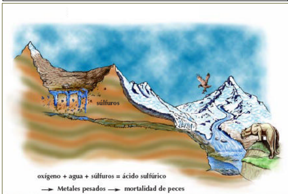
Figura 1. Proceso de generación de drenaje ácido de mina
