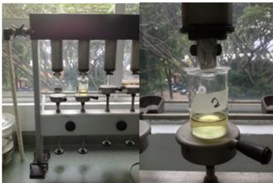
Figura 43: Determinación de grasa con quipo Soxhlet
