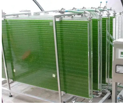
Figura 7. Fotobiorreactor de placas
