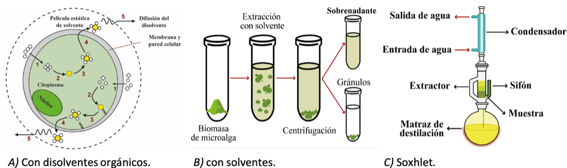
Figura 5. Proceso de extracción de lípidos utilizando cloroformo y metanol
