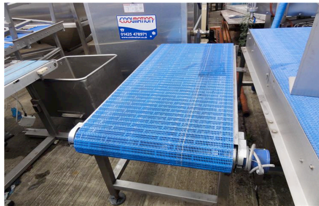
Ilustración No. 30. Banda transportadora
