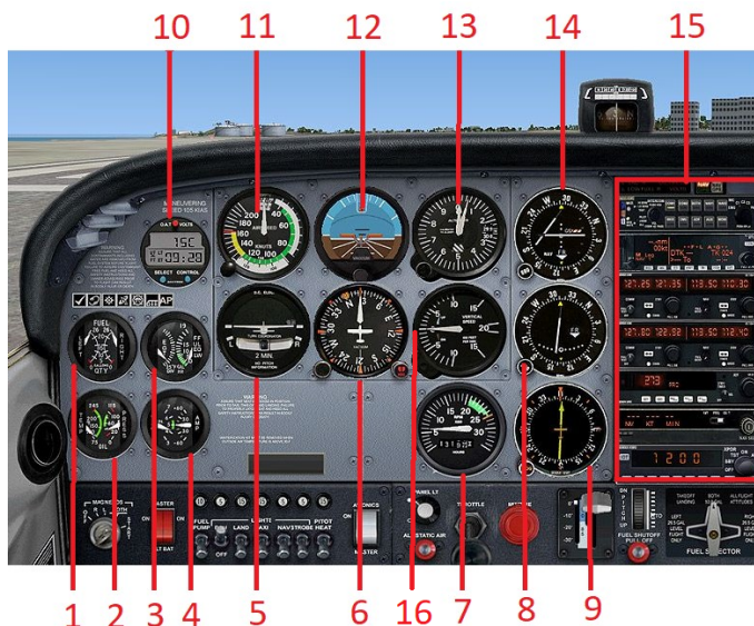
Figura 3: Distribución de instrumentos Cessna 172
