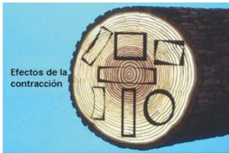
Imagen No. 48: Efectos de la contracción en la madera.
