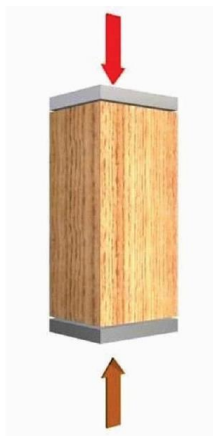
Imagen No. 50: Esquema de ensayo de compresión paralela a la fibra.
