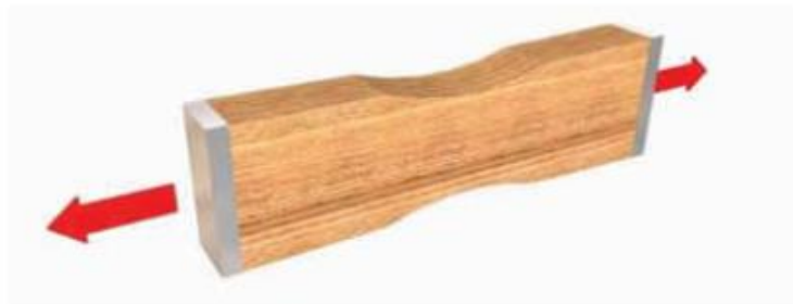
Imagen No. 52: Ensayo de tensión paralela al grano.
