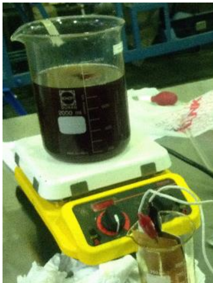
Figura 6: Proceso de operación de la celda electroquímica para el tratamiento de reducción de tiempo necesario para la separación de glicerina y biodiesel.
