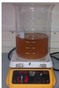
Imagen 7: Sistema de agitación de emulsión (biodiésel – glicerina) utilizando un beaker de 4 L.
