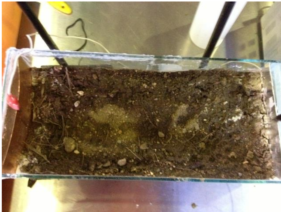
Figura 10: celda electroquímica y fuente de poder marca DC Power Supply para el tratamiento de medios edáficos con ánodo de aluminio y cátodo de cobre.
