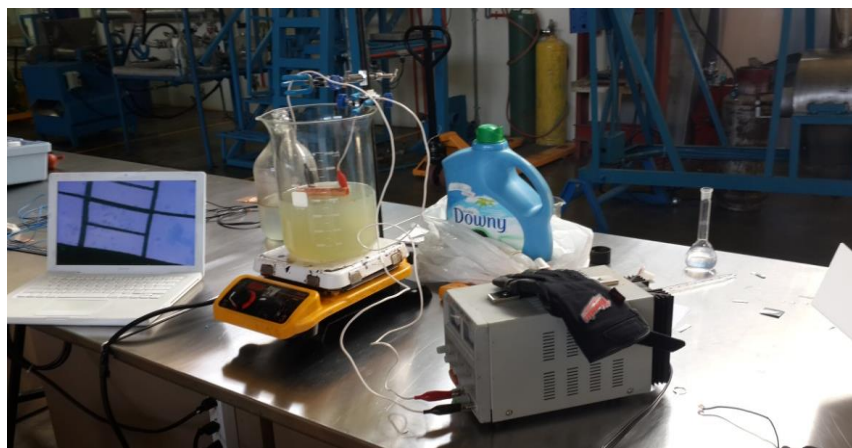
Figura 2: Celda electroquímica y fuente de poder marca DC Power Supply para el tratamiento de aguas residuales con ánodo de aluminio y cátodo de cobre antes del tratamiento electroquímico
