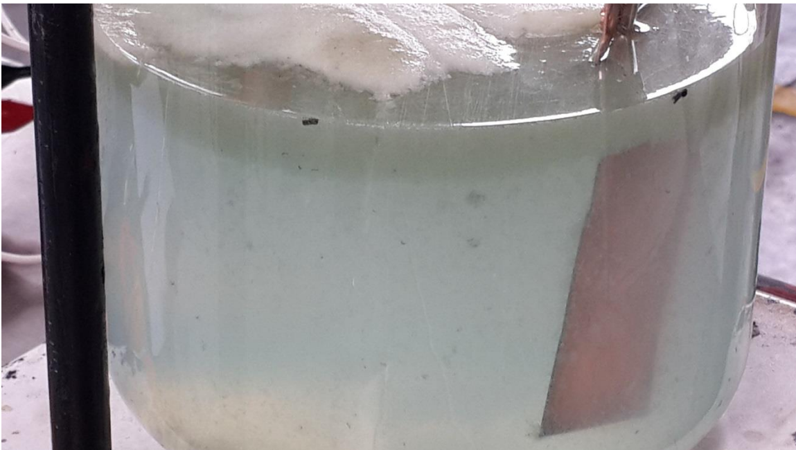
Figura 4: Reactor de la celda electroquímica para el tratamiento de aguas residuales con ánodo de aluminio y cátodo de cobre después del tratamiento electroquímico.
