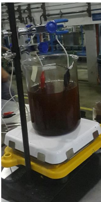
Figura 6: Proceso de operación de la celda electroquímica para el tratamiento de reducción de tiempo necesario para la separación de glicerina y biodiesel.
