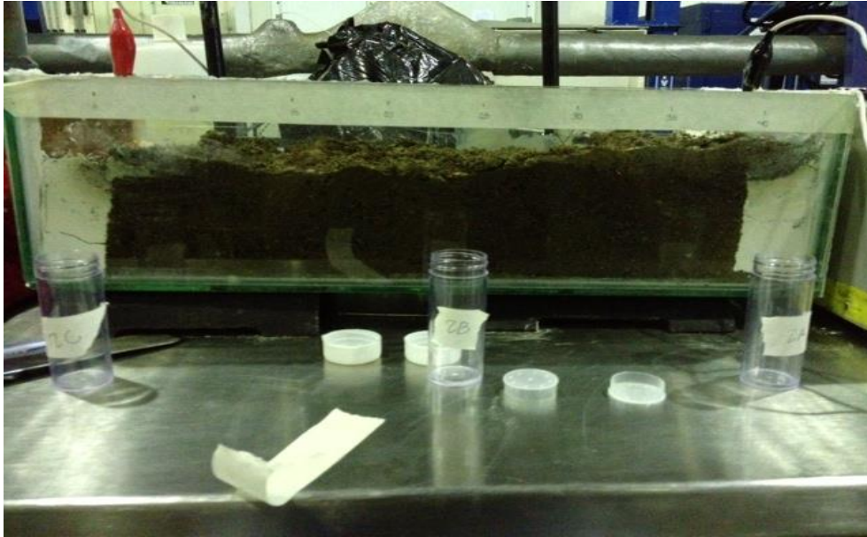
Figura 12: Muestra de Terratec utilizado para mejorar la conductividad del suelo en el tratamiento electroquímico de medio edáficos.
