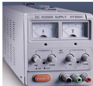
Imagen 16: Fuente de energía utilizada para realizar la metodología de decantación electrostática.
