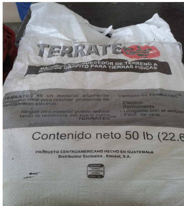
Figura 12: Muestra de Terratec utilizado para mejorar la conductividad del suelo en el tratamiento electroquímico de medio edáficos.
