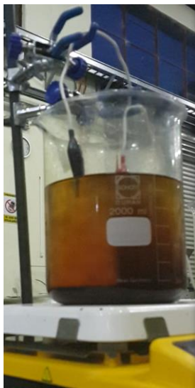
Figura 8: Separación final del área interfacial y definición del límite entre las dos fases luego del tratamiento electroquímico para la separación de glicerina y biodiésel usando ánodo de aluminio y cátodo de cobre con una corriente de 3 amperios a 30 voltios.
