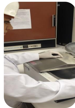
COLOCACIÓN DE MUESTRA EN BAÑO DE MARÍA PARA HOMOGENIZAR
