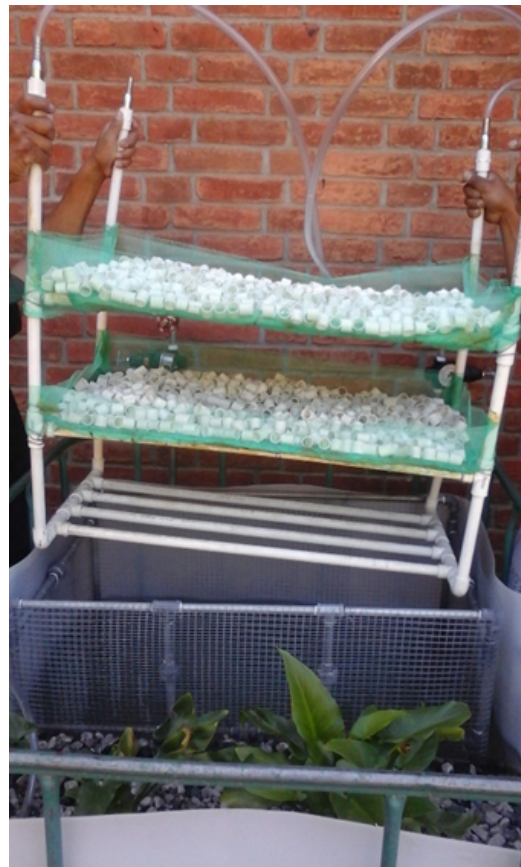
Ilustración 142: Instalación del aireador, habiendo colocado los lechos de anillos 1
