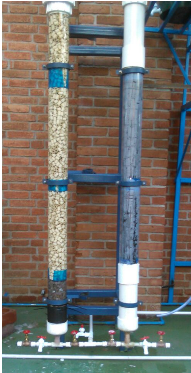
Ilustración 100: Instalación biofiltros con tubería.
