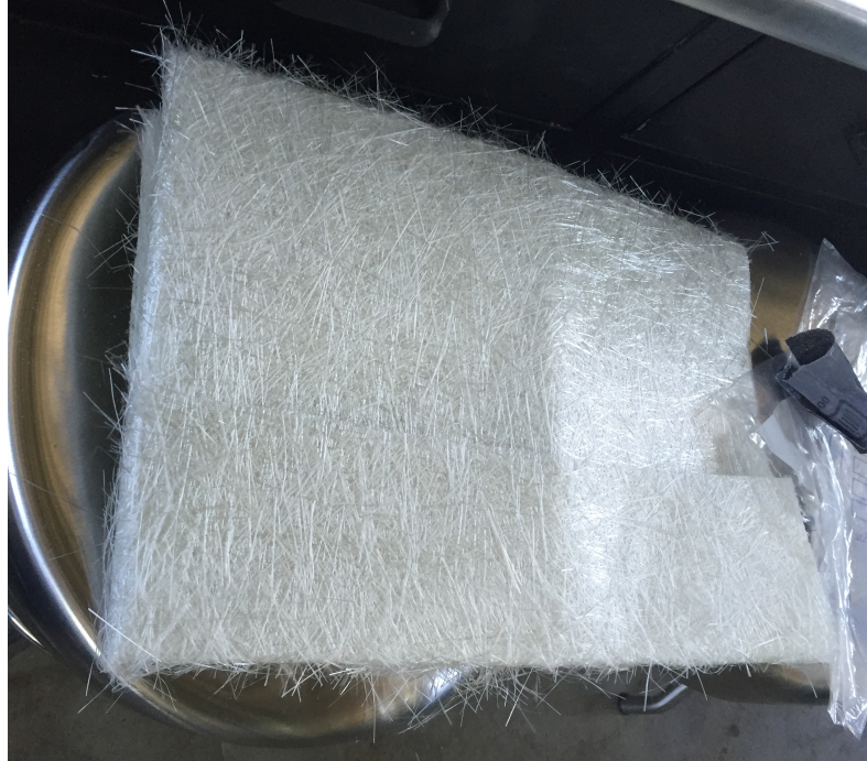
Ilustración 93: Fibra de vidrio como pegamento para cerrar fugas.
