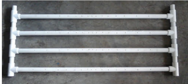
Ilustración 128: Tubos de PVC de ½", para la entrada de aire hacia los tubos perforados
