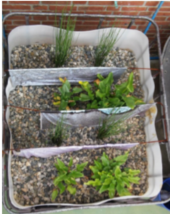
Ilustración 113: Vista superior primer humedal artificial.
