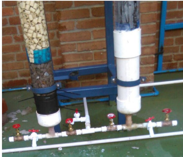
Ilustración 97: Relleno biofiltro con material filtrante BioBalls.
