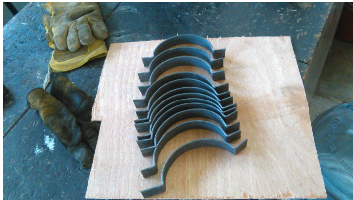
Ilustración 88: Abrazaderas acopladas a la estructura existente para el soporte de ambos biofiltros de 12 cm de diámetro.
