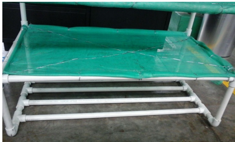
Ilustración 132: Divisiones en el aireador difusor
