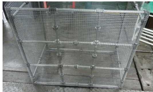
Ilustración 126: Vista isométrica de la estructura metálica de hierro galvanizado de 3/8"
