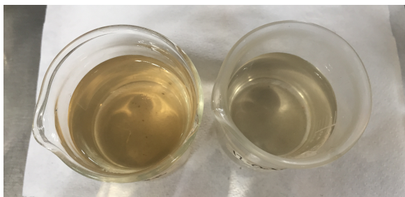
Ilustración105: Color y turbidez del agua obtenida a la salida de ambos biofiltros al día 42 de operación izquierda empaque BioBalls y derecha CPVC.
