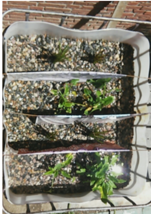
Ilustración 111: Siembra de colas de caballo y cartuchos blancos del primer humedal artificial.
