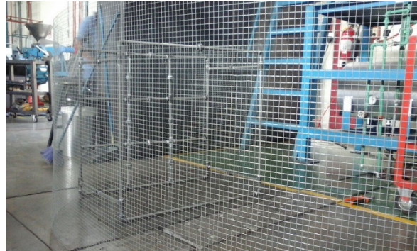
Ilustración 125: Vista frontal de la estructura metálica de hierro galvanizado de 3/8"
