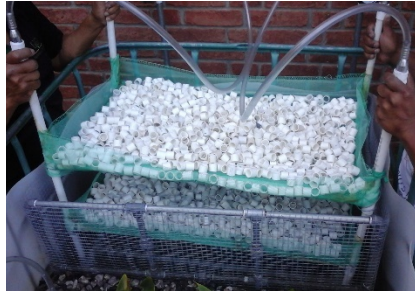
Ilustración 144: Instalación del aireador, habiendo colocado los lechos de anillos 3
