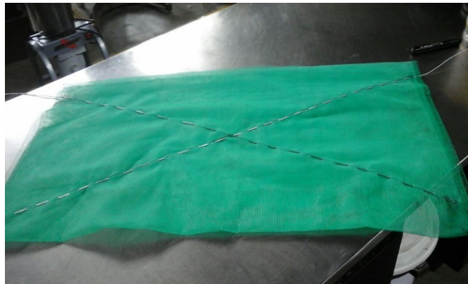
Ilustración 132: Divisiones en el aireador difusor
