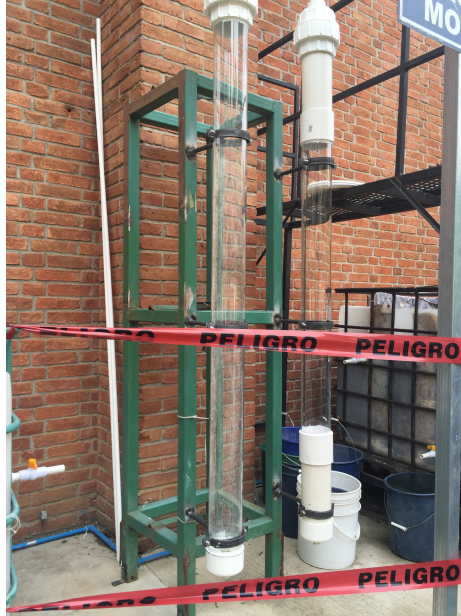
Ilustración 92: Mansilla de carro utilizada para cerrar las fugas de agua.
