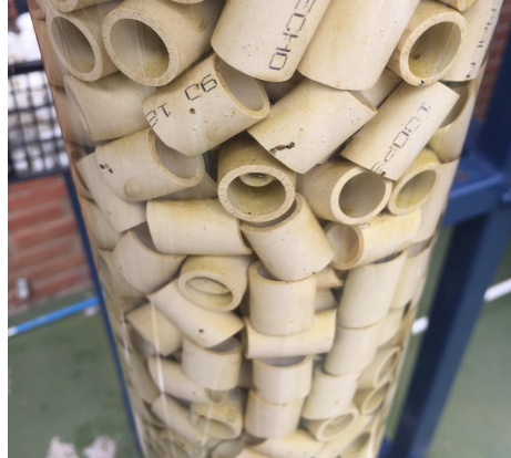
Ilustración 98: Relleno biofiltro con material filtrante CPVC de 1/8”.
