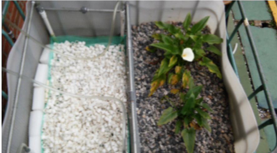
Ilustración 112: Vista superior del segundo humedal artificial, del lado derecha de la imagen, con sistema aireación, del lado izquierdo de la imagen.
