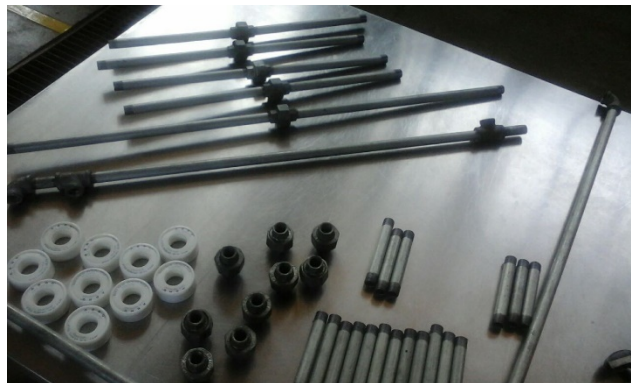
Ilustración 120: Piezas dimensionadas y accesorios: niples, tee, codos y uniones universales de hierro galvanizado de 3/8".
