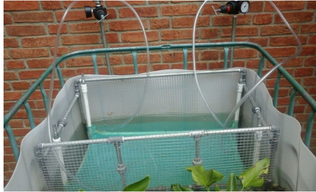
Ilustración 142: Instalación del aireador, habiendo colocado los lechos de anillos 1
