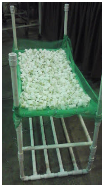
Ilustración 135: Cobertura del aireador con espuma de duroport para retener los anillos
