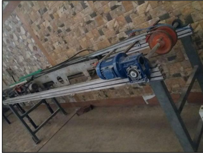
Figura 21. Implementación banda volteadora.
