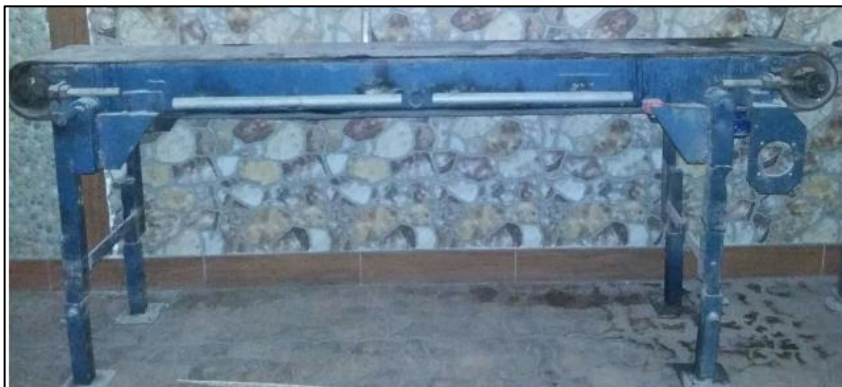
Figura 25. Implementación banda de salida
