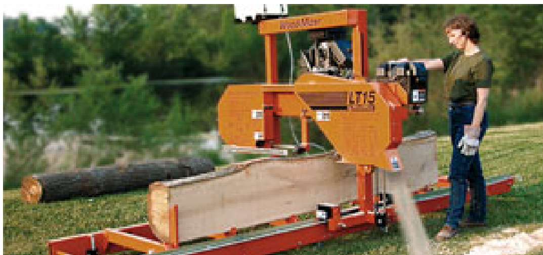
Ilustración 9: Aserradero Woodmizer LT-15 g25
