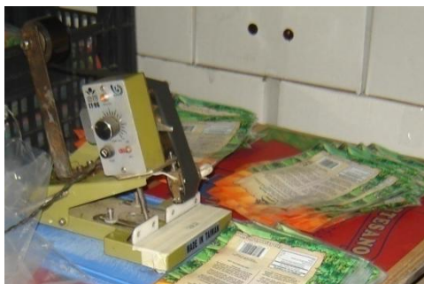
Ilustración 14. Sellador eléctrico para imprimir lote de producción y fecha de caducidad
