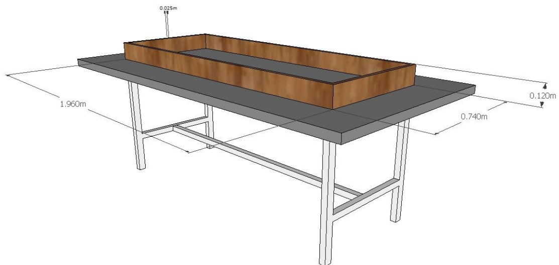
Ilustración 9. Mesa de embolsar con cajón de madera para retener manzana deshidratada
