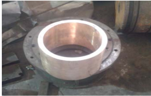
Ilustración No. 17 Chumacera de bronce para rodar transportadores helicoidales
