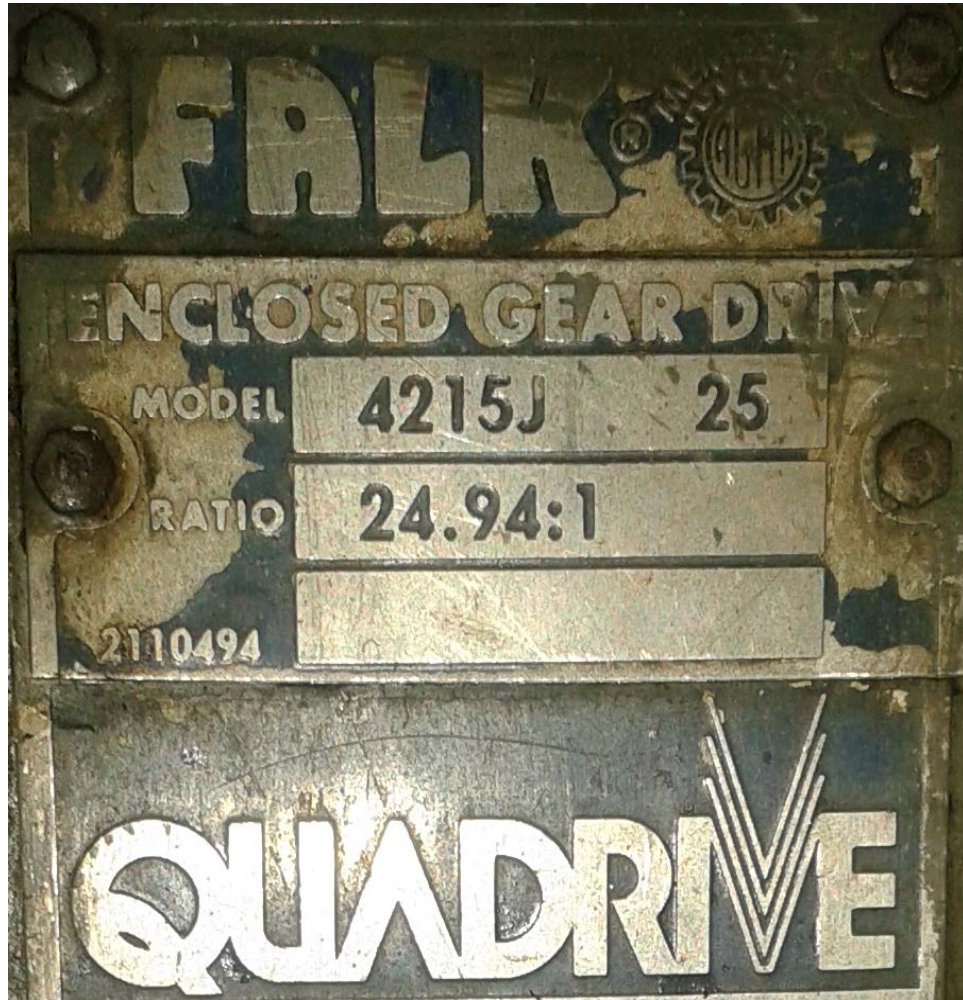
Ilustración No. 10 Placa con datos técnicos reductor de velocidad
