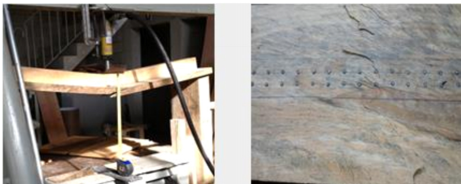
Ilustración 30 Fallo de viga unida con clavo de carpintero
