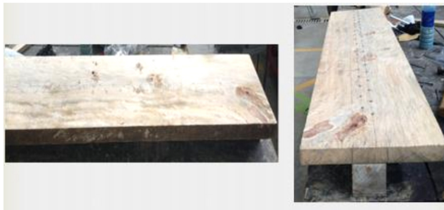
Ilustración 32 Viga unida con clavo acerado
