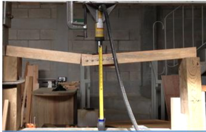
Ilustración 40 Deformación de viga unida con tirafondo acerado
