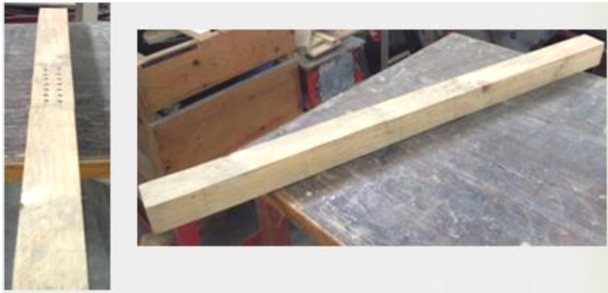
Ilustración 35 Viga una con tirafondo Xpac
