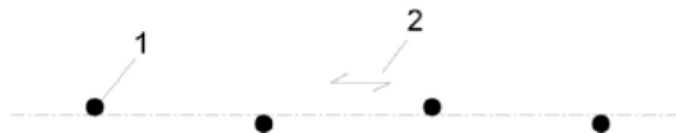
Ilustración 13 Clavo en una fila paralela a la fibra distribuidos al tresbolillo con una separación perpendicular a la fibra igual a d
