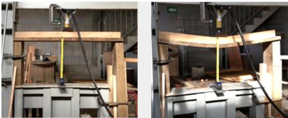
Ilustración 29 Ensayo de Viga unida con clavo de carpintero
