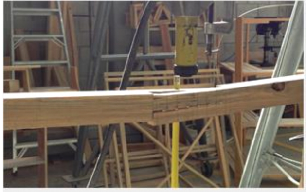
Ilustración 41 Fallo de viga unida con clavo acerado
