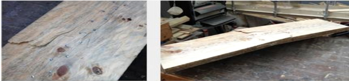
Ilustración 33 Fallo de viga con clavo acerado
