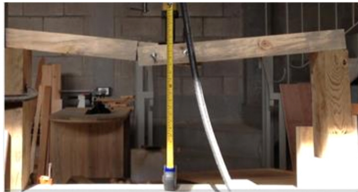
Ilustración 44 Deformación de viga unida con pernos
