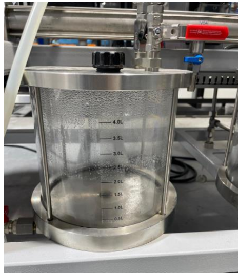
Figura 24. Fotografía del depósito de almacenamiento de producto de colas en la torre de rectificación Gunt Hamburg CE600 durante un ensayo en el Laboratorio de Operaciones Unitarias de la Universidad del Valle
