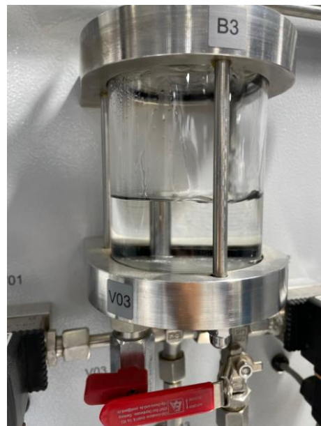
Figura 26. Fotografía del depósito de separación de fases del destilado en la torre de rectificación Gunt Hamburg CE600 durante la realización de un ensayo cuando ya se ha alcanzado el sobrenivel de reflujo en el Laboratorio de Operaciones Unitarias de la Universidad del Valle
