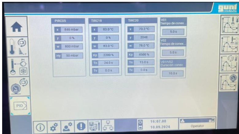
Figura 29. Fotografía de la pantalla de los parámetros de control en el panel de control de la torre de rectificación Gunt Hamburg CE600 durante la realización de un ensayo en el Laboratorio de Operaciones Unitarias de la Universidad del Valle
