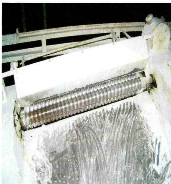
Fotografía No. 4 Formadores que habrá que modificar para obtener el diámetro deseado
