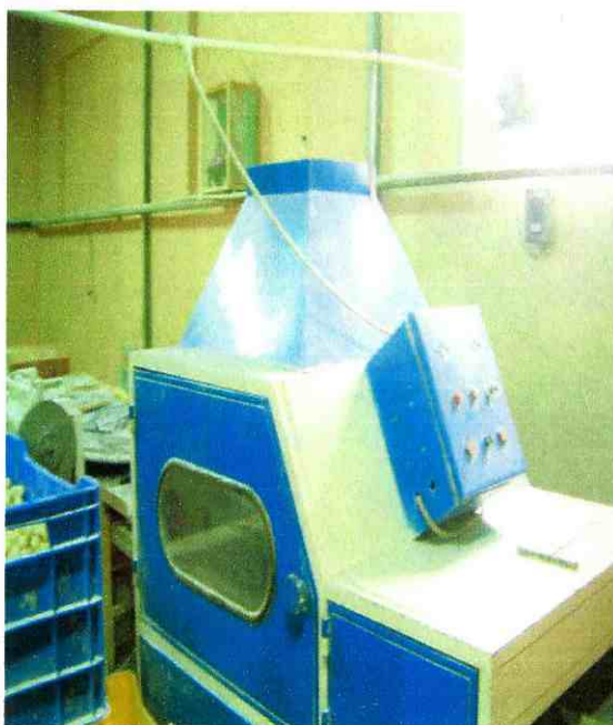
Fotografía No. 8 Equipo para el enfriamiento de las bolas de mascar
