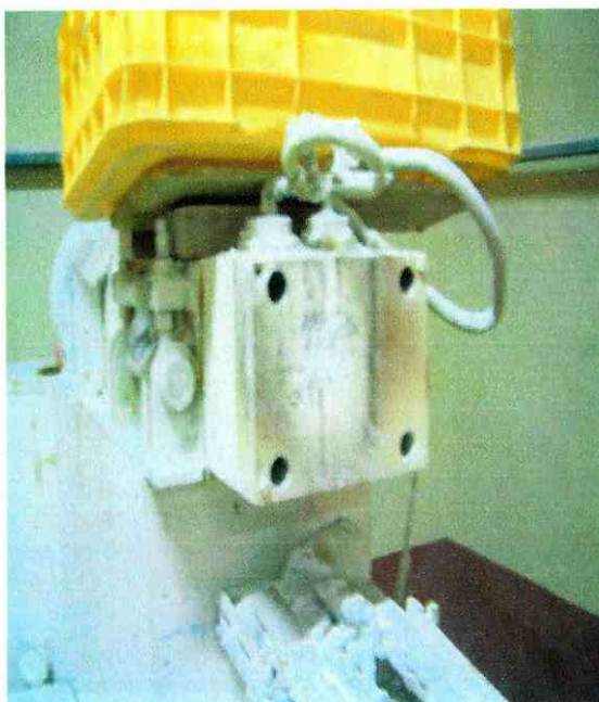
Fotografía No. 5 Dados de extrusores que habrá que modificar
