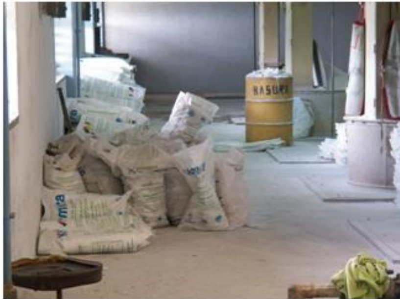
Figura No. 11. Almacenamiento de Sulfato de Aluminio
