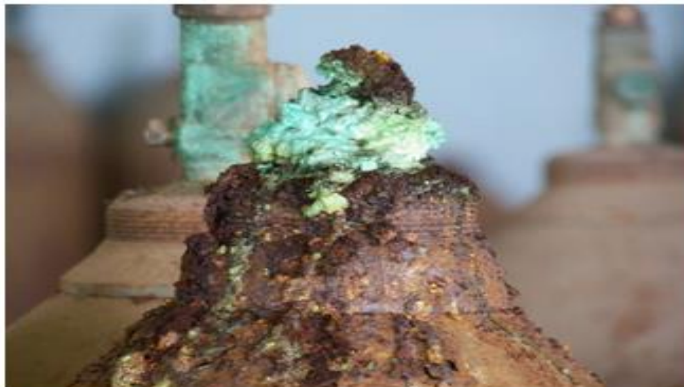
Figura No. 13. Oxidación de tuberías
