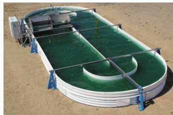
Figura 6: Laguna abierta rectangular con rueda de paleta
