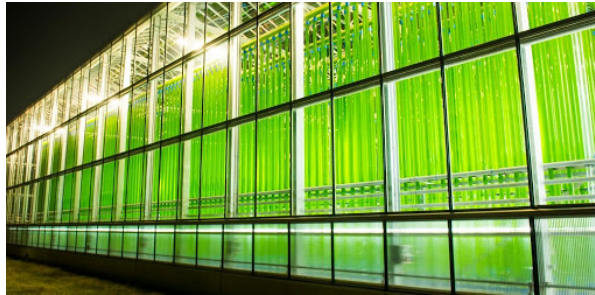
Figura 14: Planta de producción a gran escala de biomasa a partir de microalgas de la empresa Ecoduna Fuente: Ecoduna, s.f.
