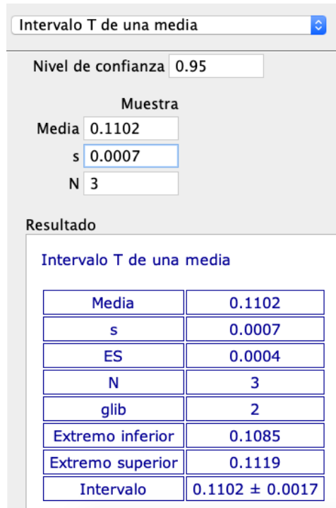
Figura 58: Determinación del intervalo de confianza para el kLa a un flujo de CO 2 de 8.28 \times 10^7 m 3 /s utilizando Geogebra
