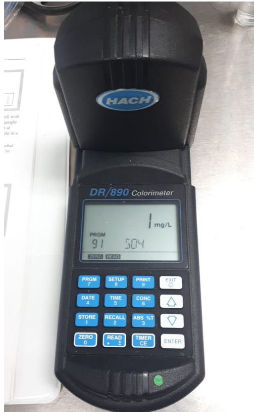
Figura 75: Medición de la concentración de sulfatos utilizando el colorímetro HATCH para los cultivos con variación de flujo de CO 2
