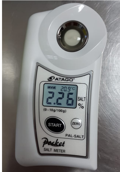
Figura 71: Medición de salinidad utilizando el medidor Atago en el Reactor 1 con flujo de \text{CO}_2 de 2.11 \times 10^{-7} \text{ m}^3/\text{s}
