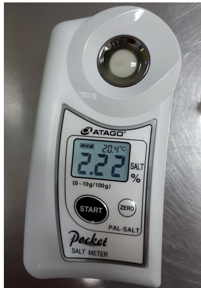
Figura 72: Medición de salinidad utilizando el medidor Atago en el Reactor 2 con flujo de \text{CO}_2 de 3.00 \times 10^{-7} \text{ m}^3/\text{s}
