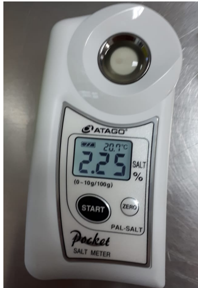
Figura 73: Medición de salinidad utilizando el medidor Atago en el Reactor 3 con flujo de CO 2 de 8.28 \times 10^{-7} m 3 /s
