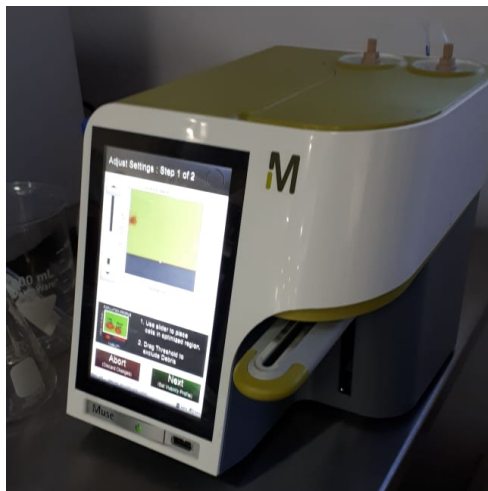
Figura 31: Contador de células Muse® utilizado para construir las curvas de crecimiento de la microalga
