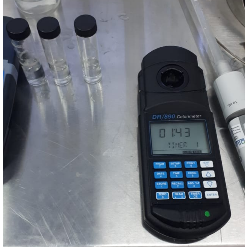
Figura 34: Colorímetro HACH utilizado para determinar la concentración de nitratos, fosfatos y
