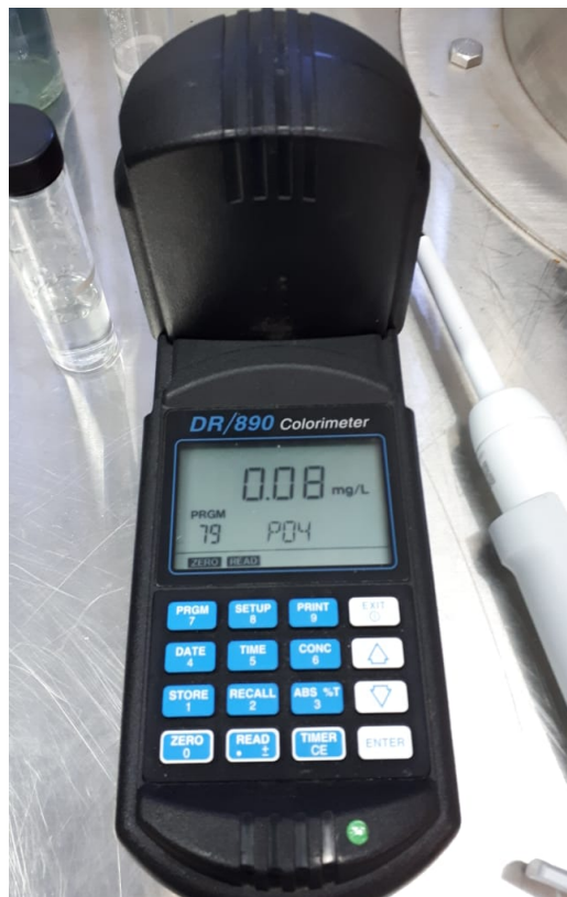
Figura 74: Medición de la concentración de fosfatos utilizando el colorímetro HATCH para los cultivos con variación de flujo de CO 2
