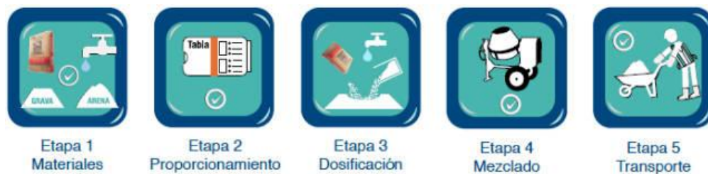
Ilustración No. 20: Proceso de elaboración del concreto.
