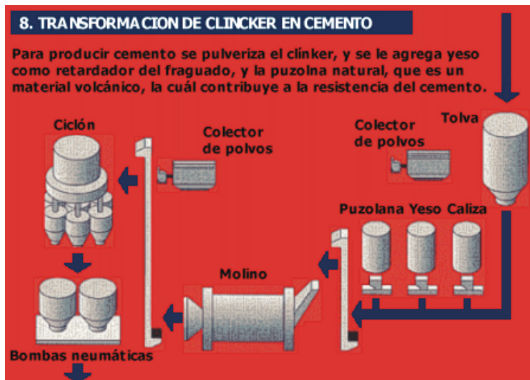
Ilustración No. 16: Transformación de clinker en cemento.
