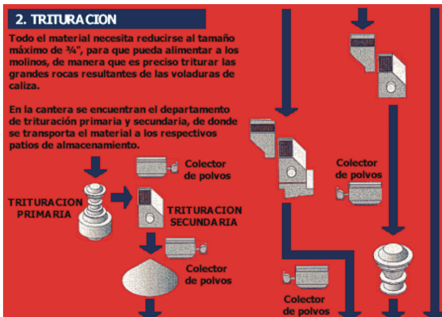
Ilustración No. 12: Trituración primaria y secundaria de materias primas.
