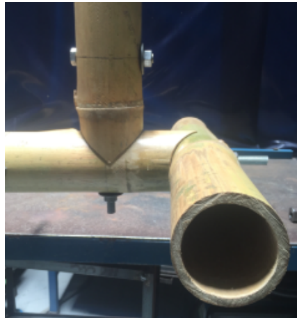
Figura 22. Vista lateral de conexión de pernos tensores
