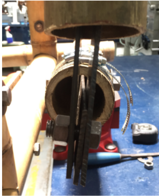
Figura 32. Junta entre balancín y biela.
