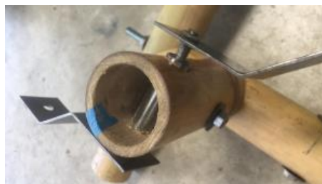
Figura 26. Sistema de manivela y pivote trasero.
