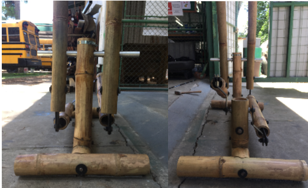
Figura 31. Máquina elíptica armada sin soporte de pies y antideslizante.
