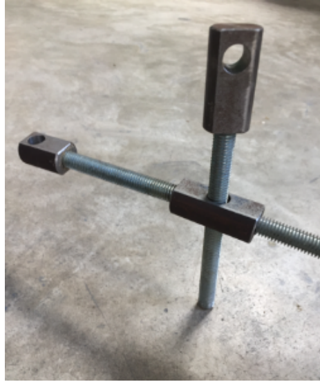
Figura 21. Sistemas de perno tensor intersectados.
