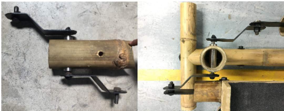
Figura 35. Sistema manivela, eje y pivote traseros (izquierdo); Vista superior de sistema manivela, eje trasero, pivote trasero (derecha).
