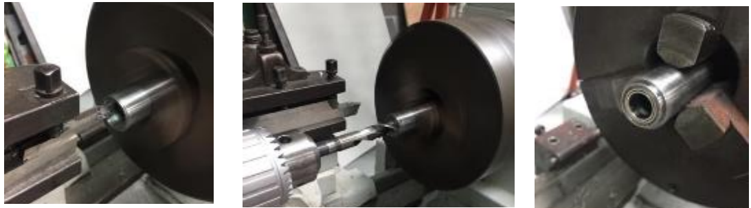
Figura 24. Proceso de manufactura de eje secundario.
