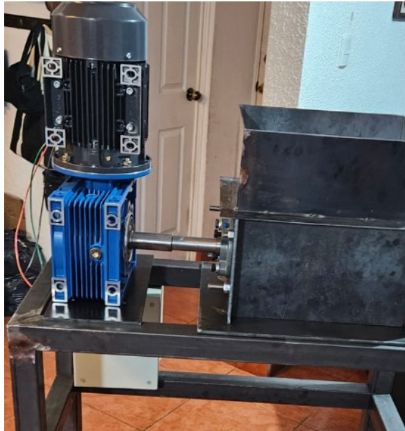
Figura 20. Presentación del motorreductor y la caja de trituración
