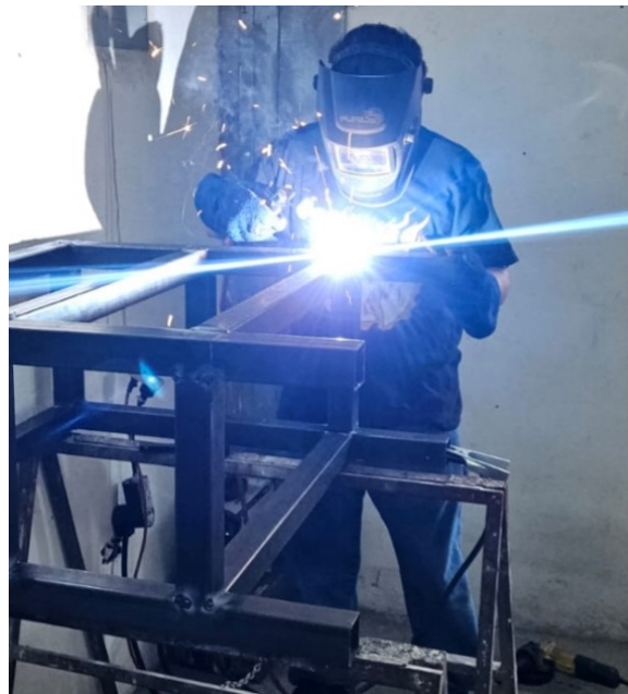
Figura 39. Soldadura de la estructura base
