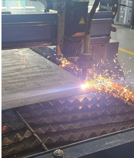
Figura 36. Corte CNC de la cuchilla
