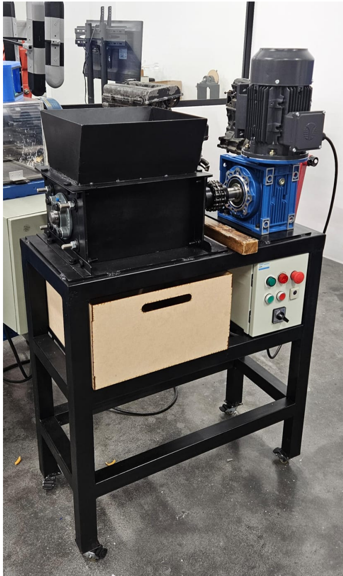
Figura 22. Trituradora ensamblada y pintada
