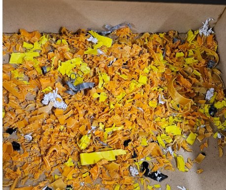
Figura 24. Primera prueba de triturado (PLA)
