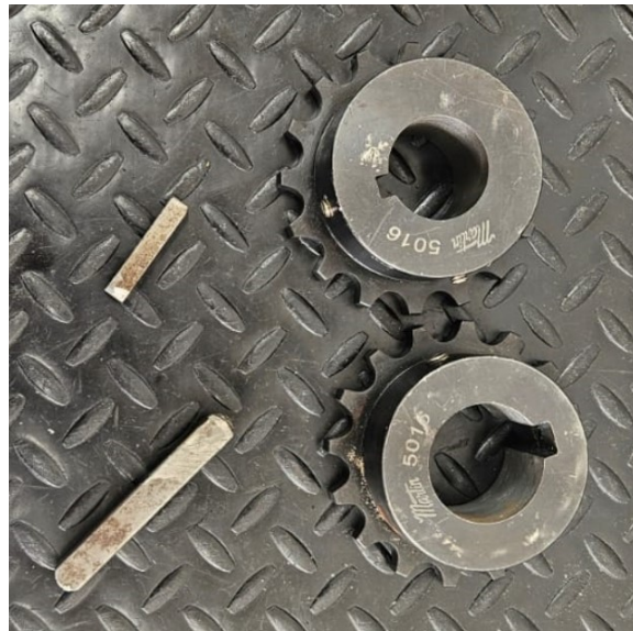
Figura 10. Acoples mecanizados para la transmisión por cadena
