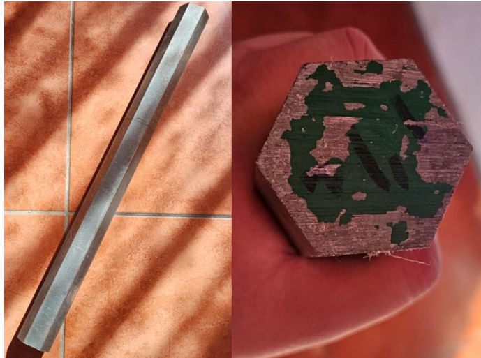
Figura 44. Perfil hexagonal de acero AISI 1018
