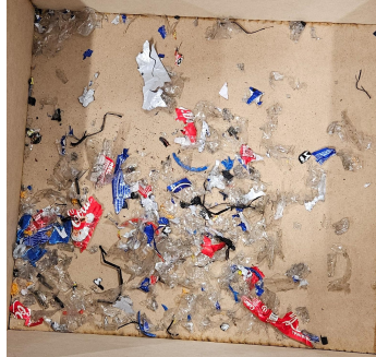
Figura 26. Resultado de trituración (PET)
