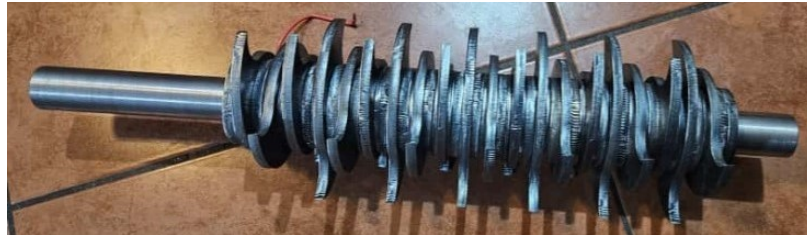
Figura 17. Eje de trituración ensamblado
