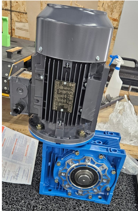
Figura 43. Motorreductor seleccionado (2 Hp, 30 RPM)
