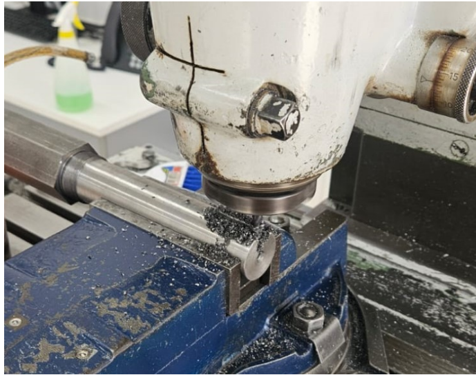
Figura 38. Mecanizado de la cuña del eje en fresadora
