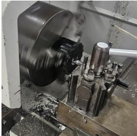
Figura 40. Mecanizado de acoples en torno CNC
