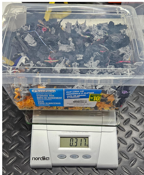
Figura 25. Resultado de trituración (PLA)
