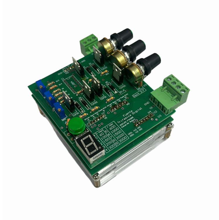
Figura 45: Ensamblaje físico final fuente trifásica digital
