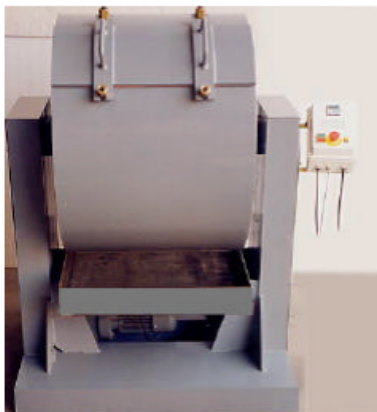
Imagen 42. Molino de bolas utilizado, situado en el Laboratorio de Operaciones Unitarias de la Universidad del Valle de Guatemala.
