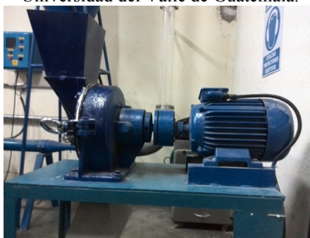
Imagen 41. Molino de discos utilizado, situado en el Laboratorio de Operaciones Unitarias de la Universidad del Valle de Guatemala.
