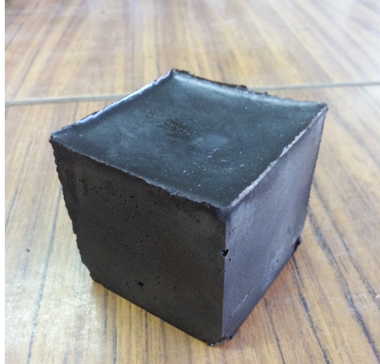
Imagen 49. Geopolímero a base de arena volcánica, obtenido en el Laboratorio de Materiales de la Universidad del Valle de Guatemala.
