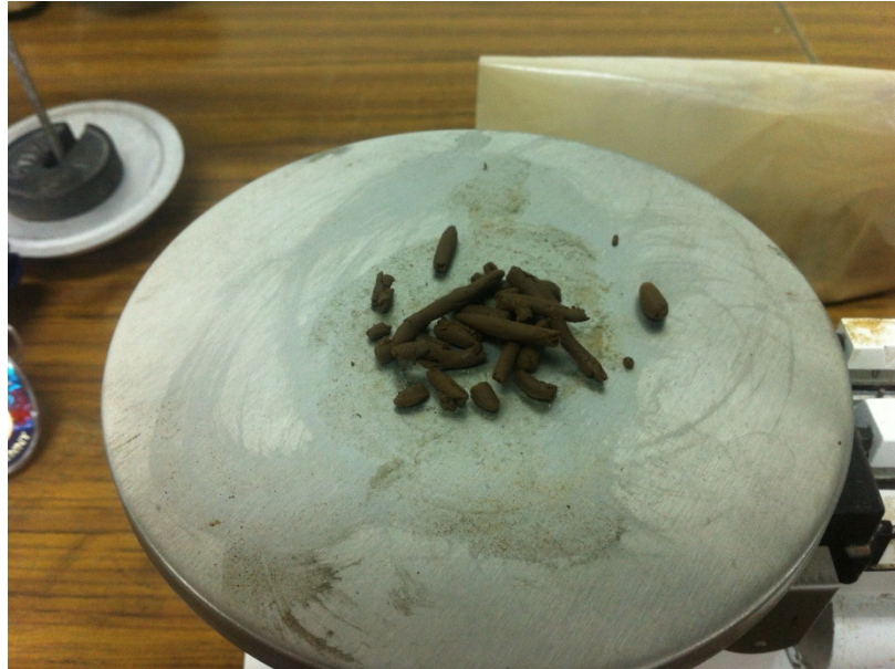
Imagen 38. Determinación límite plástico arcilla, realizado en el Laboratorio de Materiales de la Universidad del Valle de Guatemala.
