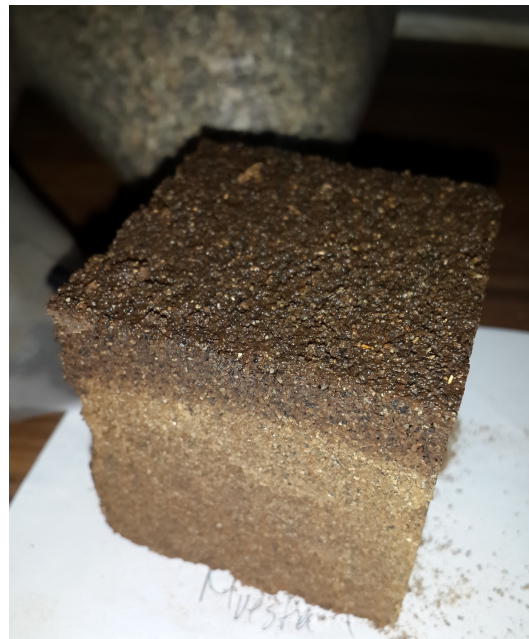
Imagen 50. Geopolímero a base de arcilla, obtenido en el Laboratorio de Materiales de la Universidad del Valle de Guatemala.
