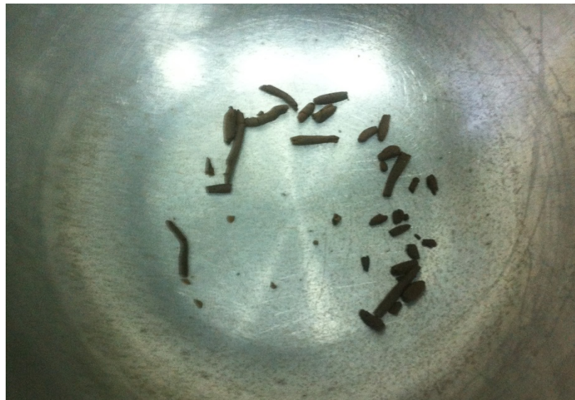
Imagen 39. Determinación límite plástico arcilla, realizado en el Laboratorio de Materiales de la Universidad del Valle de Guatemala.
