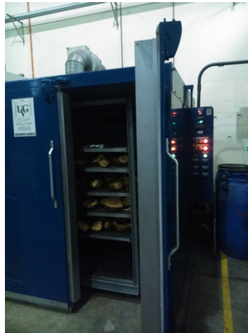
Imagen 40. Horno deshidratador utilizado, situado en el Laboratorio de Operaciones Unitarias de la Universidad del Valle de Guatemala.
