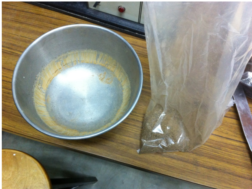
Imagen 35. Determinación de fineza de arcilla, realizado en el Laboratorio de Materiales de la Universidad del Valle de Guatemala.
