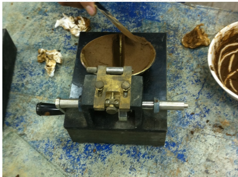
Imagen 33. Determinación del límite líquido arcilla, realizado en el Laboratorio de Materiales de la Universidad del Valle de Guatemala.
