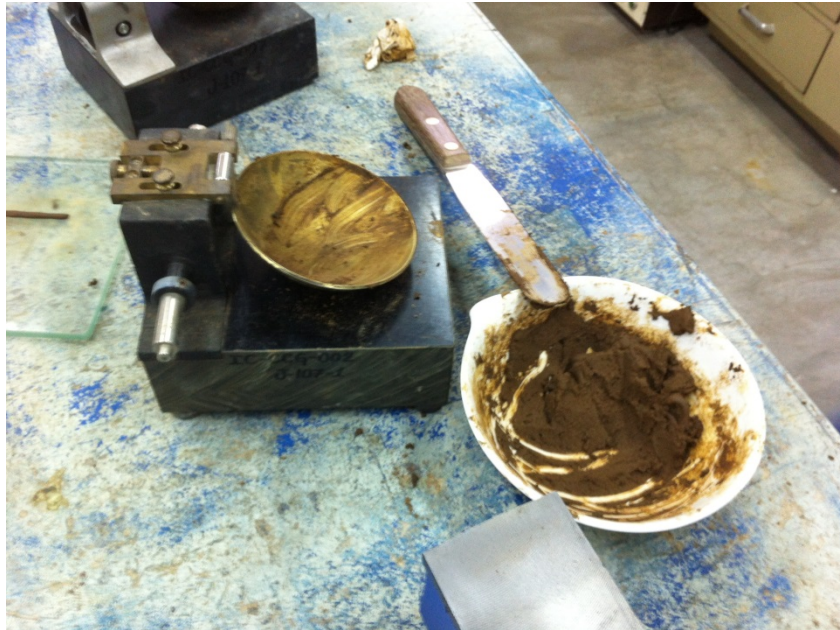
Imagen 32. Determinación del límite líquido arcilla, realizado en el Laboratorio de Materiales de la Universidad del Valle de Guatemala.
