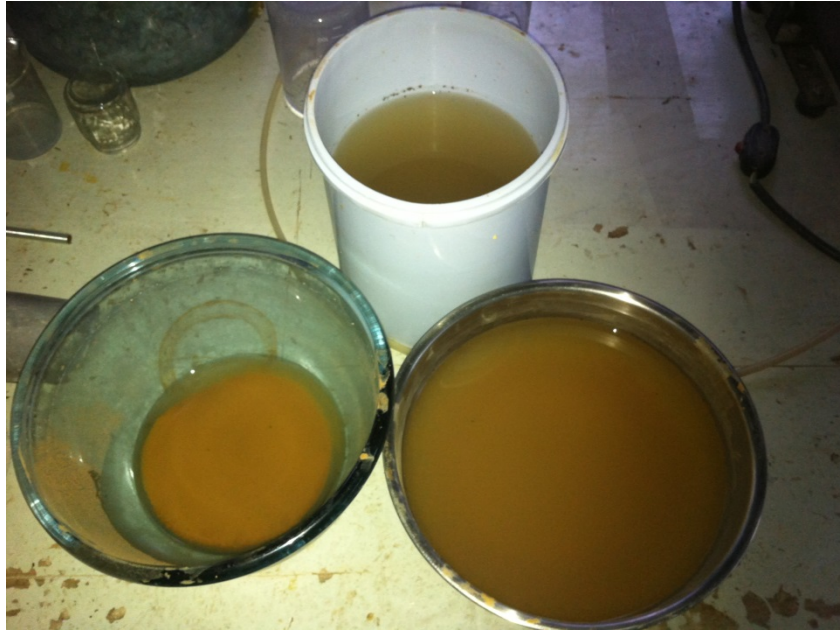
Imagen 34. Determinación de fineza de arcilla, realizado en el Laboratorio de Materiales de la Universidad del Valle de Guatemala.
