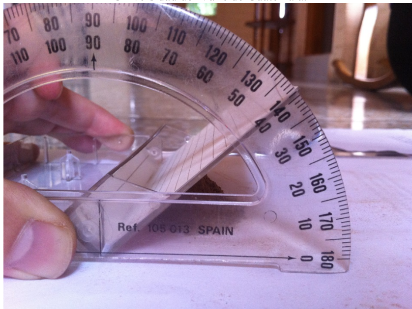
Imagen 36. Determinación ángulo de reposo arcilla, realizado en el Laboratorio de Materiales de la Universidad del Valle de Guatemala.
