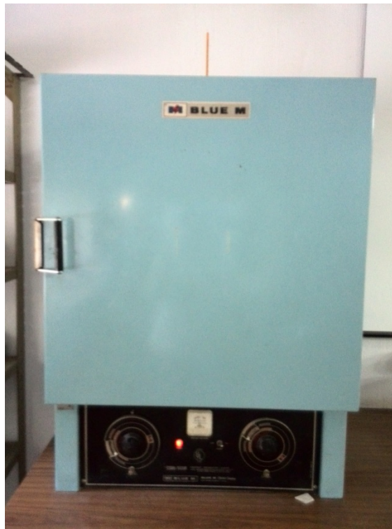
Imagen 46. Horno utilizado para el proceso de curado, situado en Laboratorio de Materiales de la Universidad del Valle de Guatemala.
