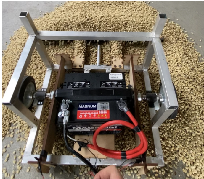
Figura 67: Prueba de motores y su nuevo diseño de soporte
