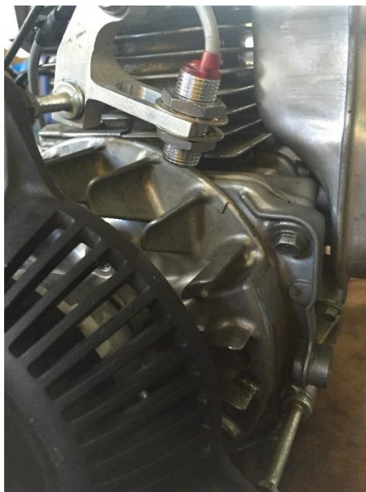
Figura 13: Marca de la aleta que señala PMS del motor
