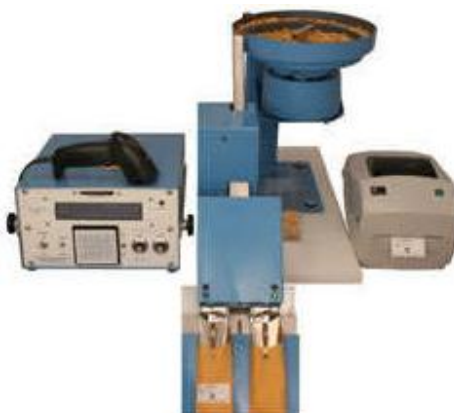
Figura11: Contadora de granos marca International Marketing and Design Co, modelo U
