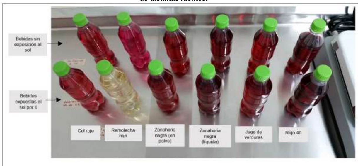
Figura 28. Efectos de la exposición al sol sobre bebidas saborizadas de fresa utilizando antocianinas de distintas fuentes.
