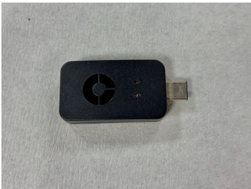
Figura 18. Equipo de voltamperometría SensitSmart
