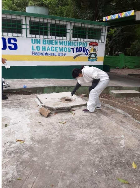
Figura No. 25. Imagen de la toma de muestra en la fosa séptica de los servicios sanitarios en el área recreativa de la playa pública del lago Amatlán
