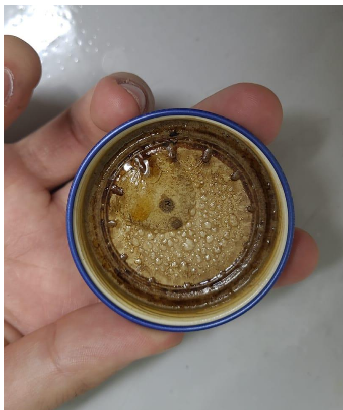
Figura 43: Corrosión de tapadera de frasco debido al bioaceite
