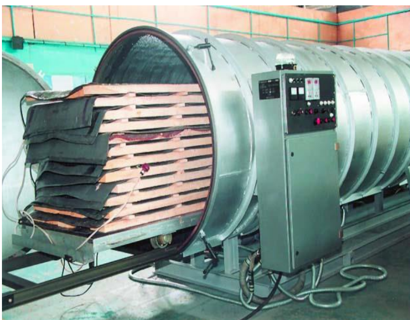
Gráfico No. 24: Cámara de secado de madera al vacío
