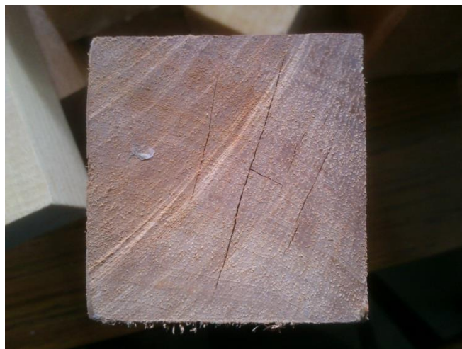
Gráfico No. 68: Rajadura por secado de madera
