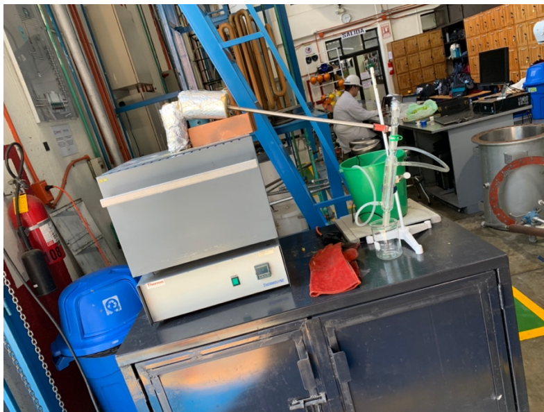
Figura 21. Imagen del sistema utilizado para llevar a cabo el proceso de pirólisis de polietileno de alta densidad.
