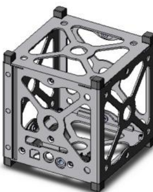
Figura 87 Diseño de la estructura del CubeSat Kit.
