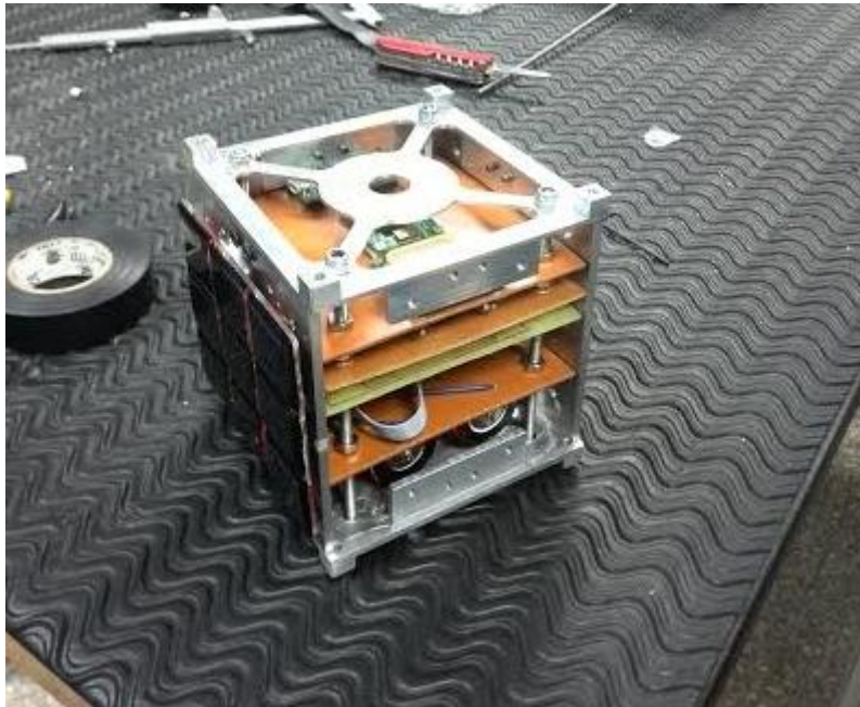
Figura 72 Ensamblaje del CubeSat 1U isométrico 1.
