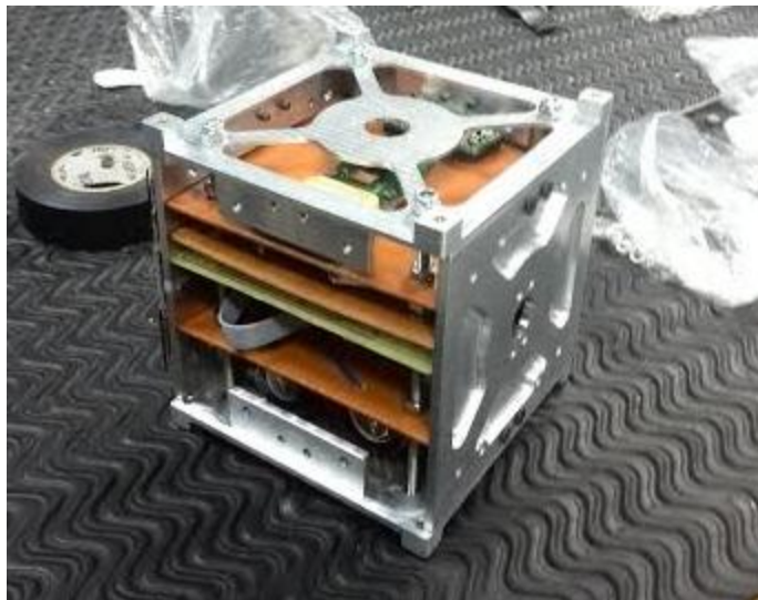
Figura 73 Ensamblaje del CubeSat 1U isométrico 2.
