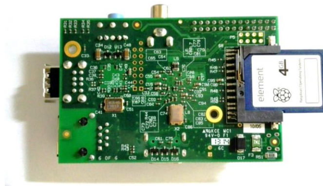
Figura 84. Conexión de la tarjeta SD a la Raspberry Pi.
