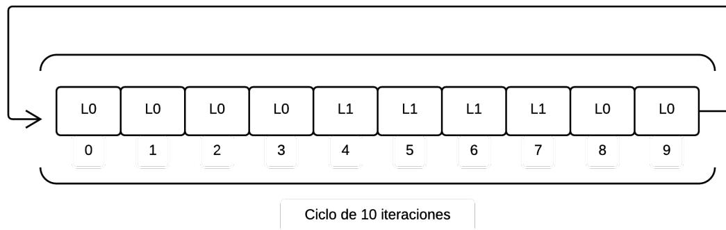
Figura 47. Diagrama de asignación de luces de semáforos para un ciclo de 10 iteraciones en el simulador de traffic cellular automaton .
