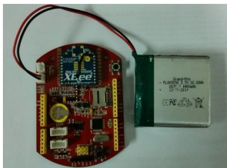
Figura 78. Conexión del dispositivo XBee al Seeeduino.
