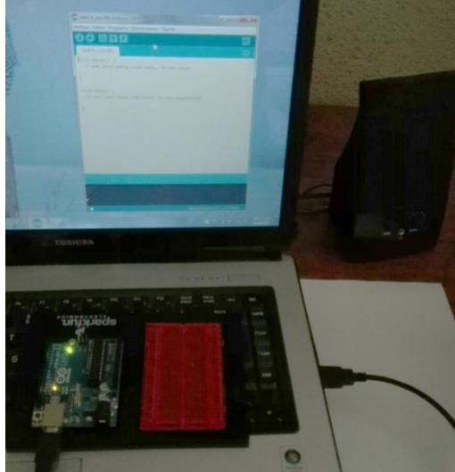
Figura 73. Conexión de Arduino Uno a una computadora con la interfaz de programación de Arduino instalada.
