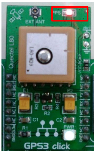
Figura 149. Fotografía de módulo GPS3 Click en funcionamiento (led rojo).
