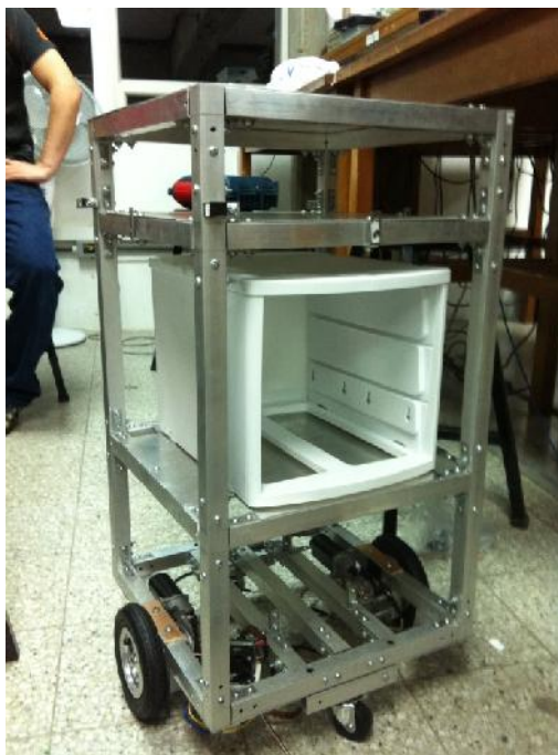
Figura No. 18 Estructura con motores
