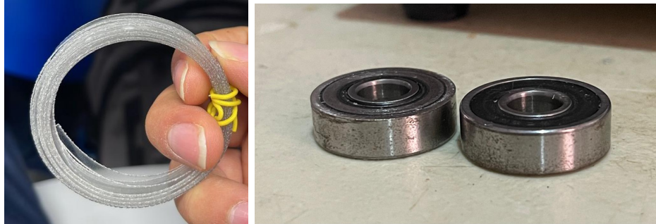
Figura 22. Tiras PET producidas y cojinetes afilados para el sistema de corte
