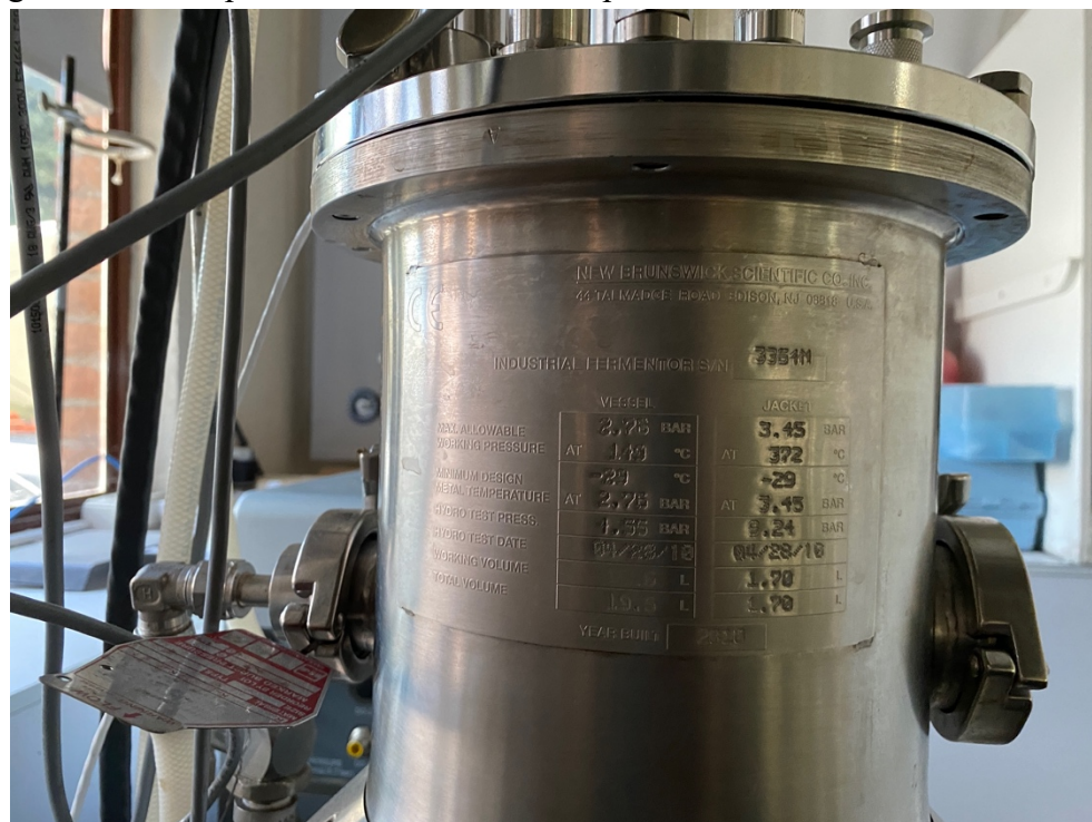
Figura 46. Datos placa del reactor utilizado para las fermentaciones
