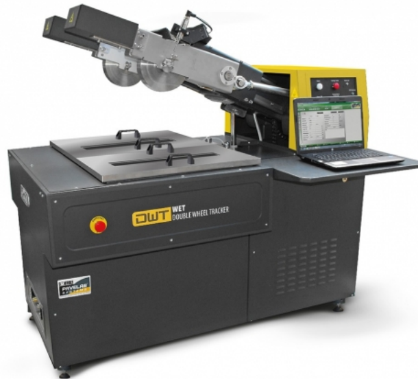
Figura 62: Máquina de rueda cargada de Hamburgo o Rueda de Hamburgo (ADATEC, 2015)
