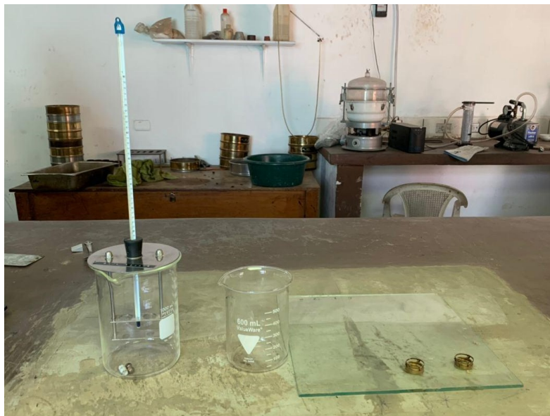
Figura 55: Equipo utilizado para el punto de ablandamiento
