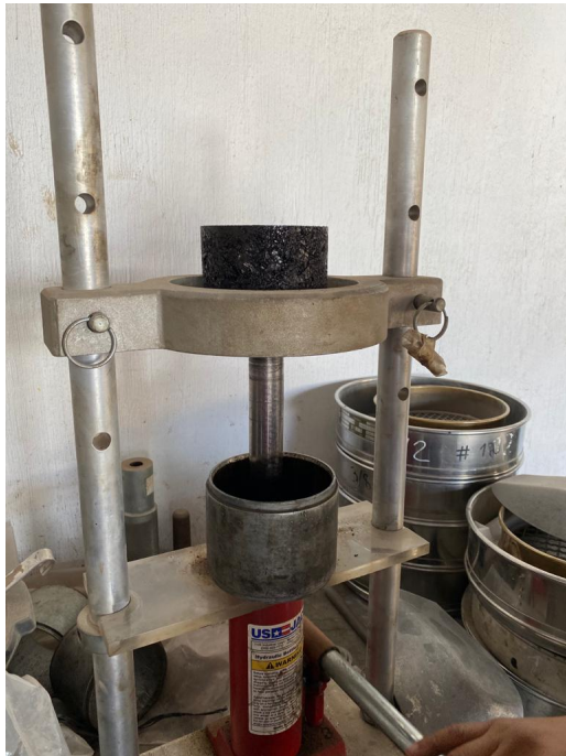
Figura 85: Extracción de la probeta del molde cilíndrico
