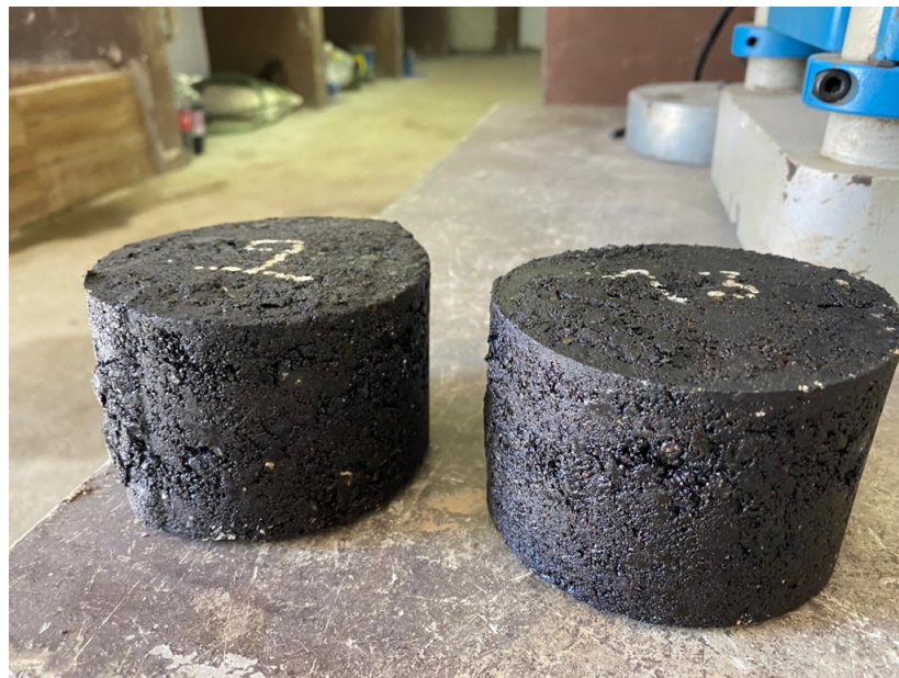
Figura 58: Probeta de concreto asfáltico convencional y modificado 1
