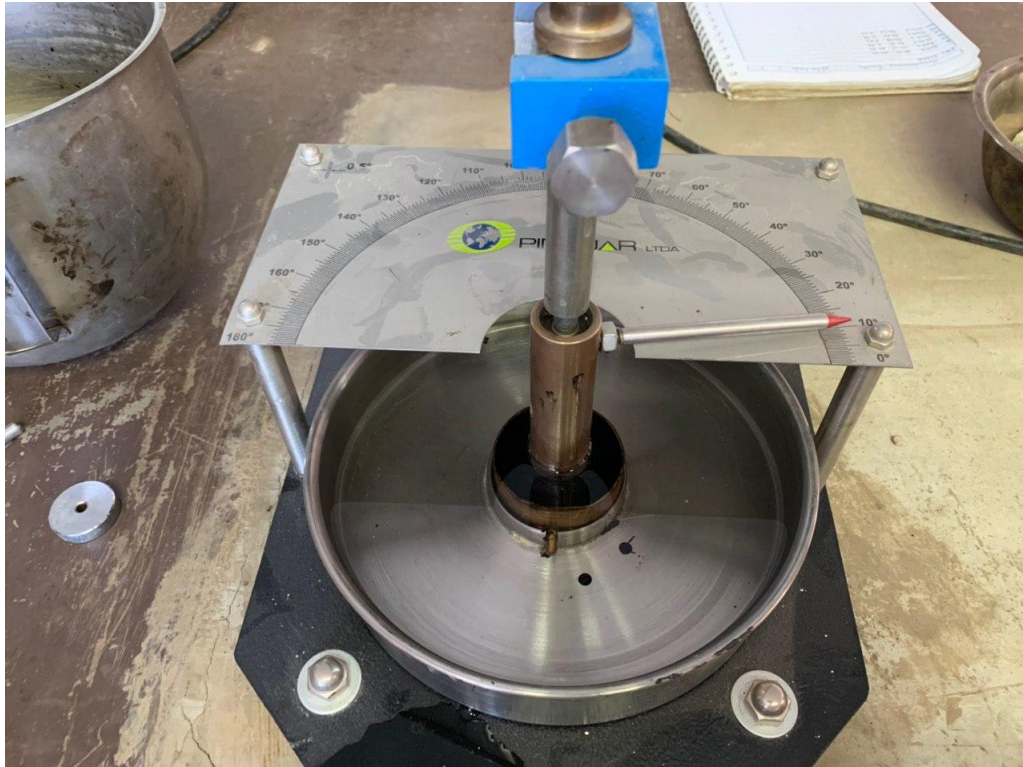
Figura 78: Resultado del ensayo de recuperación elástica por torsión para el cemento asfáltico convencional
