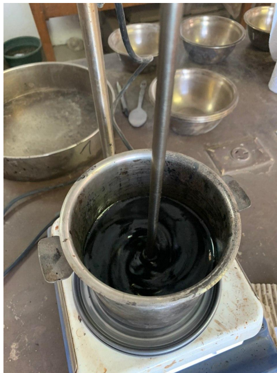
Figura 57: Mezclado del aditivo con el asfalto
