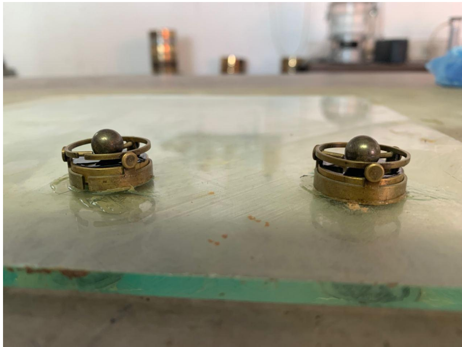
Figura 79: Colocación del cemento asfáltico convencional en anillos de soporte y de bolas de aceros
