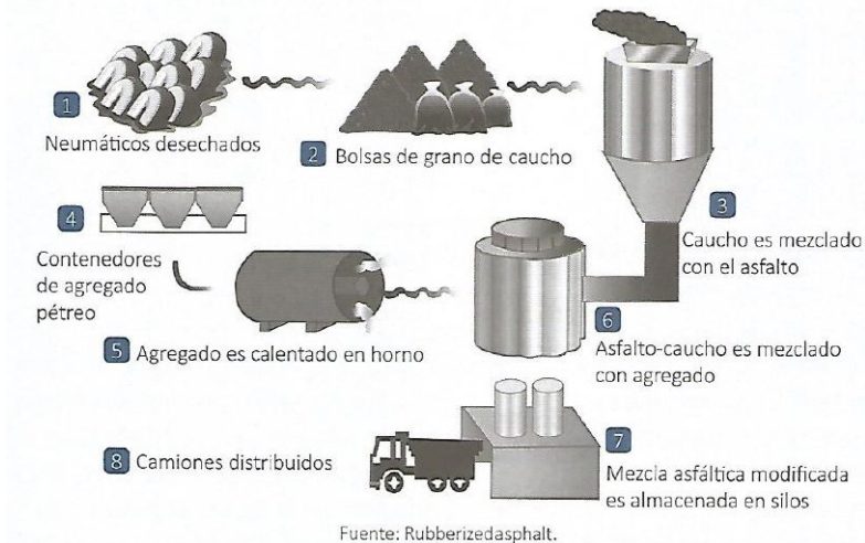
Figura 25: Proceso de producción de asfalto modificado con caucho (Rondón & Reyes, 2015)
