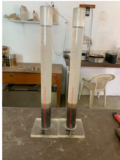
Figura 74: Ensayo de equivalente de arena después de la sedimentación
