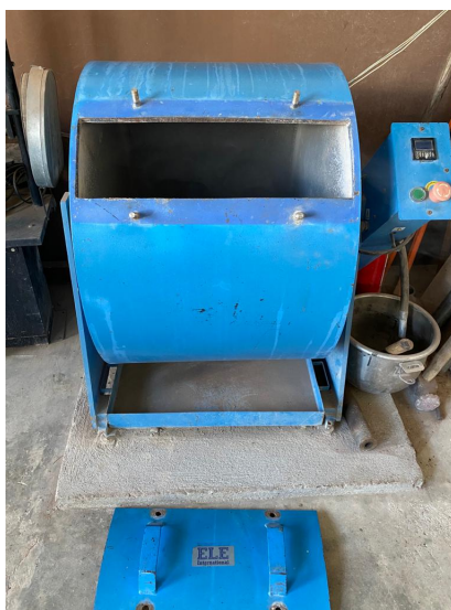
Figura 42: Máquina de los ángeles con vista en su interior
