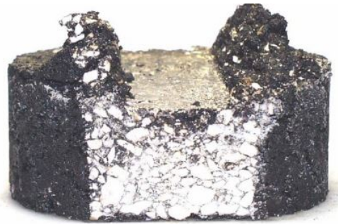
Figura 89: Ejemplo de falla de la rueda de Hamburgo (Fitts, 2020)
