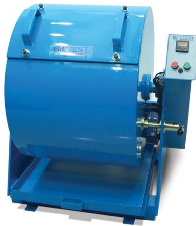
Figura 22: Máquina de los ángeles (UTEST, 2016)
