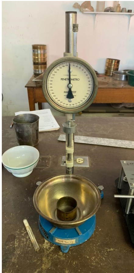
Figura 53: Equipo utilizado para el ensayo de penetración
