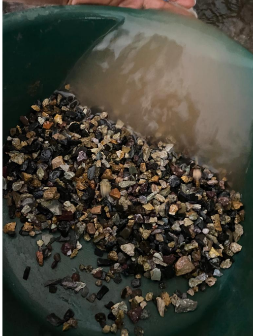
Figura 76: Lavado de agregado para determinación de la gravedad específica del agregado
