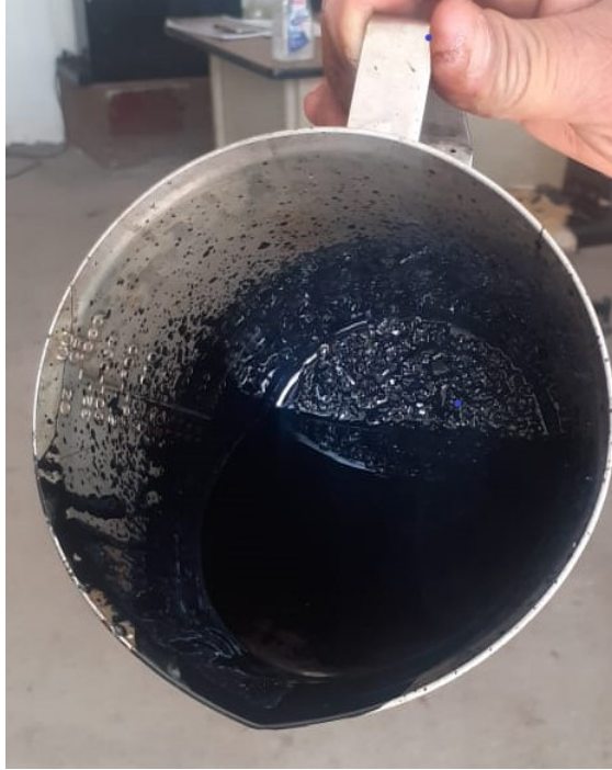
Figura 66: Resultado de la modificación del cemento asfáltico con tereftalato de polietileno
