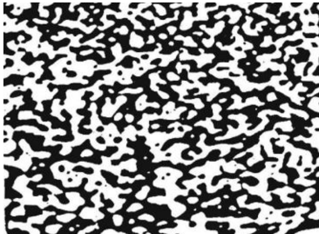
Figura 15: Ligante modificado con dos fases - microestructura - contenido de polímero del 5% (Reyes, 2003)
