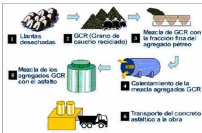
Figura 12: Proceso de adición de caucho vía seca (Díaz & Castro, 2017)
