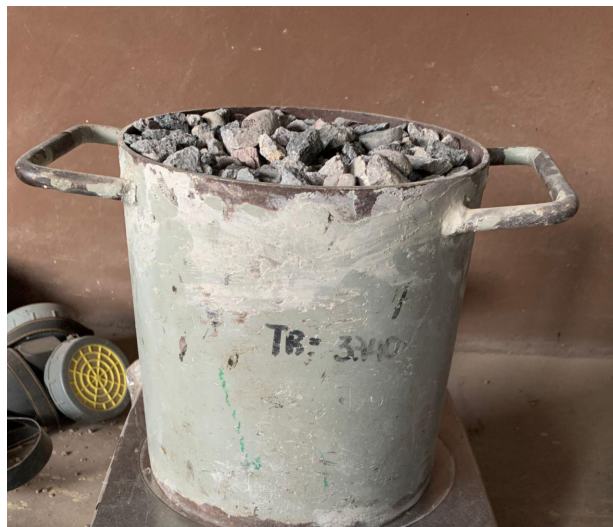
Figura 46: Recipiente y agregados utilizados para medir el peso unitario
