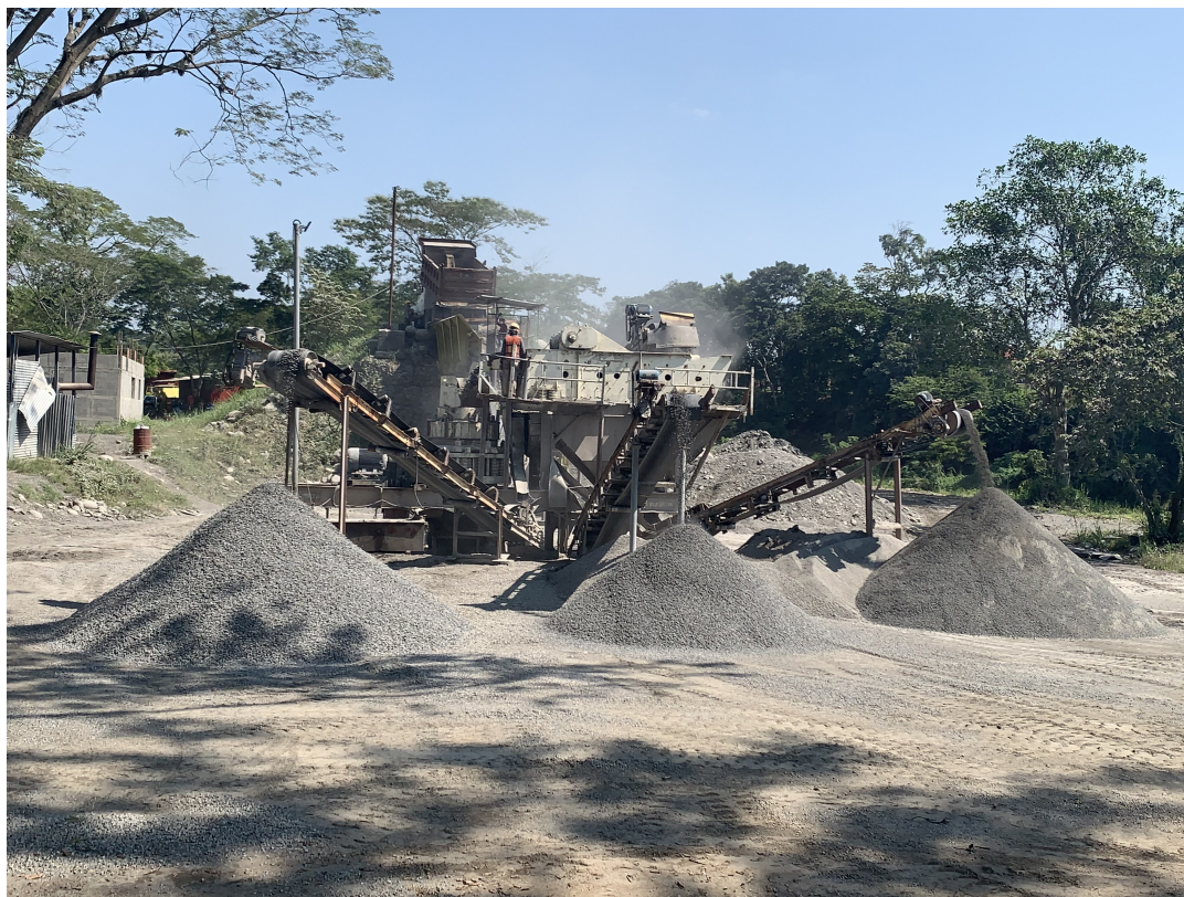
Figura 21: Agregados pétreos provenientes de una planta de trituración
