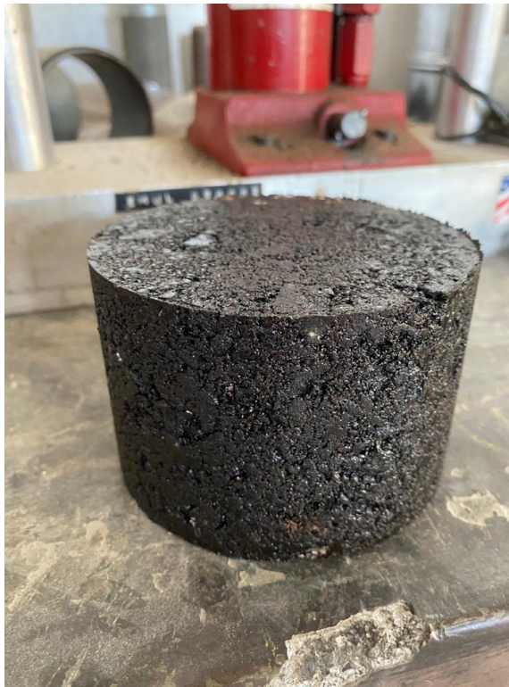
Figura 86: Probeta de concreto asfáltico modificado luego de su extracción del molde
