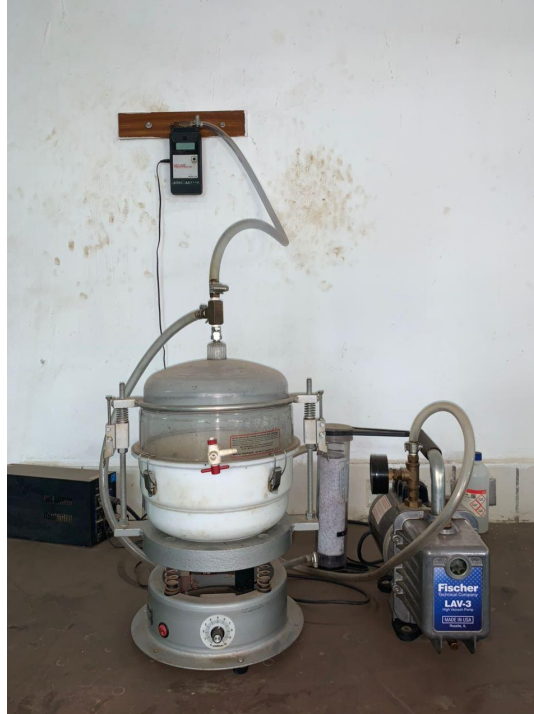
Figura 60: Equipo utilizado para la gravedad específica teórica máxima
