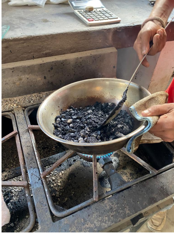
Figura 84: Mezclado de agregados pétreos y cemento asfáltico
