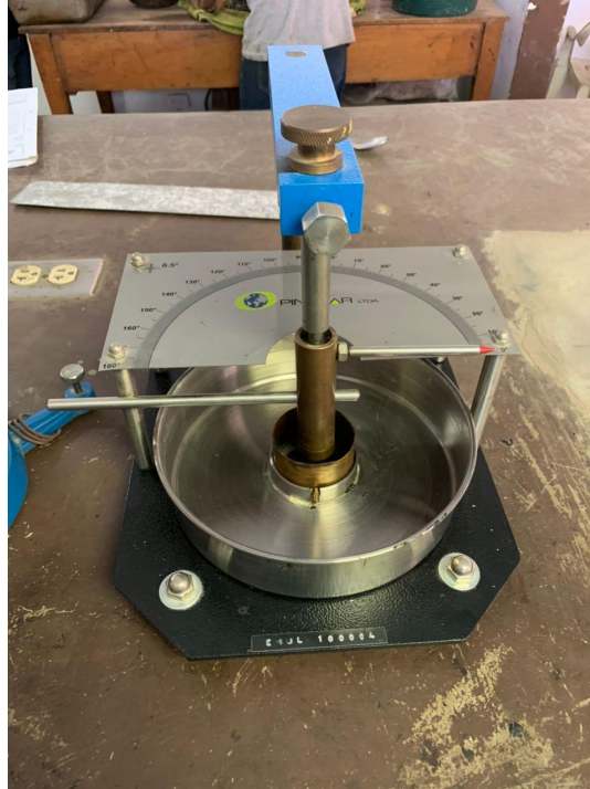
Figura 54: Equipo utilizado para el ensayo de recuperación elástica por torsión
