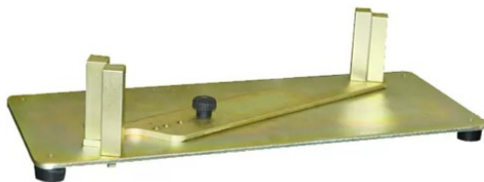
Figura 23: Calibrador proporcional para el índice de aplanamiento y alargamiento (Contenco, 2019)
