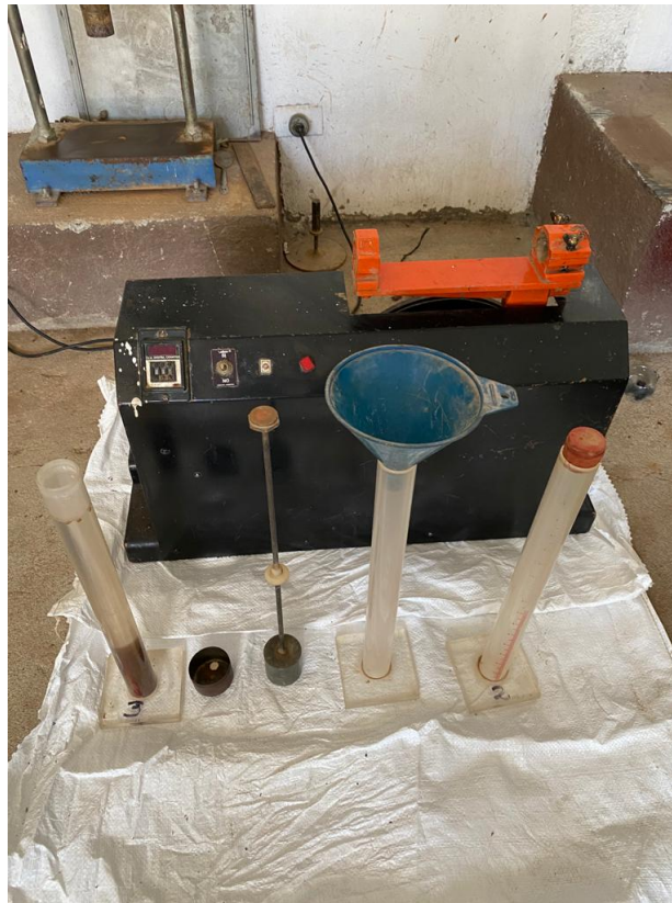
Figura 41: Equipo utilizado para el ensayo de equivalente de arena
