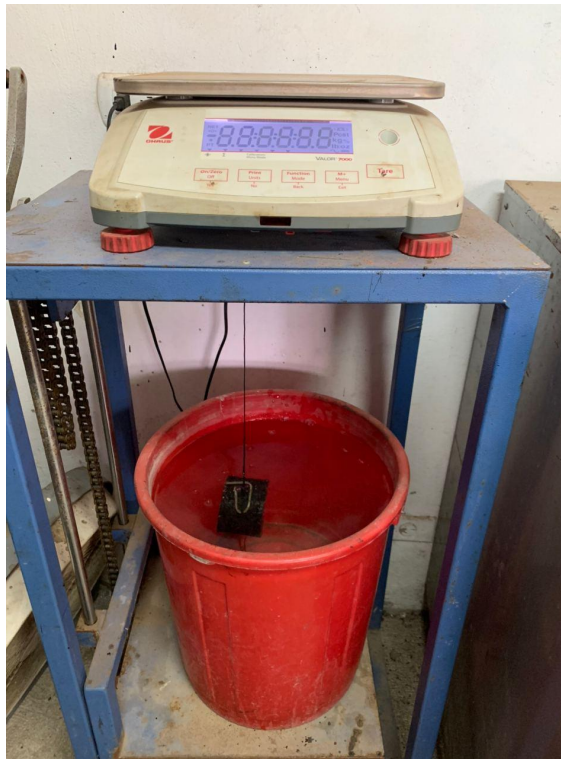
Figura 59: Peso de probeta suspendida en agua
