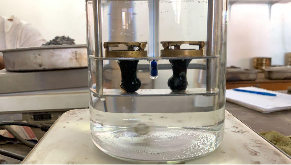
Figura 80: Resultado de punto de ablandamiento para el cemento asfáltico modificado
