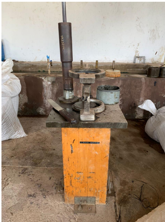
Figura 83: Martillo de compactación de operación manual
