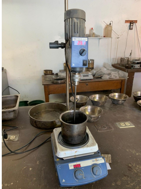
Figura 56: Equipo utilizado para el proceso de mezclado del aditivo con el asfalto
