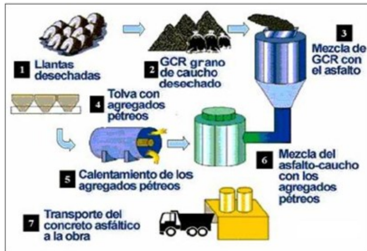
Figura 11: Proceso de adición de caucho vía húmeda (Díaz & Castro, 2017)
