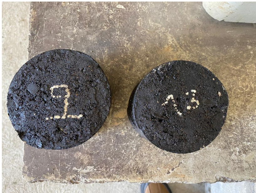
Figura 87: Vista en planta de probeta de concreto asfáltico convencional y modificado
