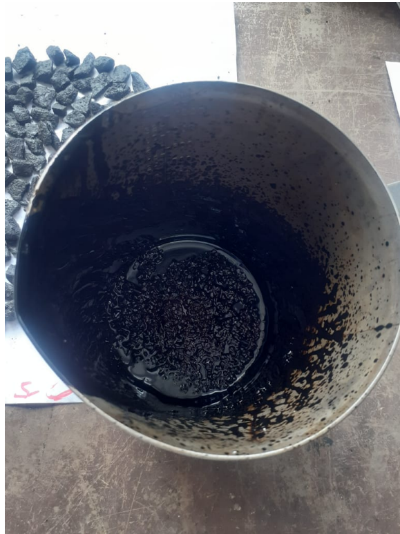
Figura 67: Sedimentación del PET en el cemento asfáltico
