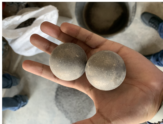
Figura 75: Esferas de acero que se utilizan en la máquina de los ángeles
