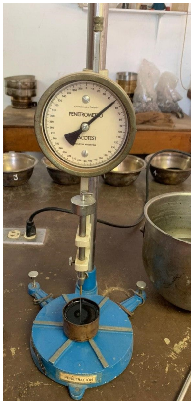
Figura 77: Realización del ensayo de penetración para el cemento asfáltico modificado
