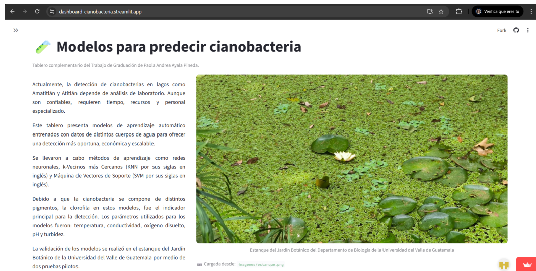
Figura 71. Tablero digital interactivo empleado para la visualización y análisis de los modelos de aprendizaje automático desarrollados en este trabajo.
