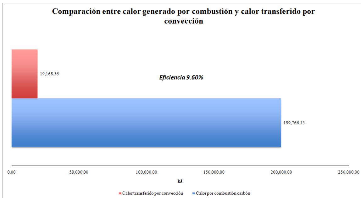
Gráfico 45. Comparación entre el calor generado por la combustión del carbón y el calor transferido por convección en el secador.
