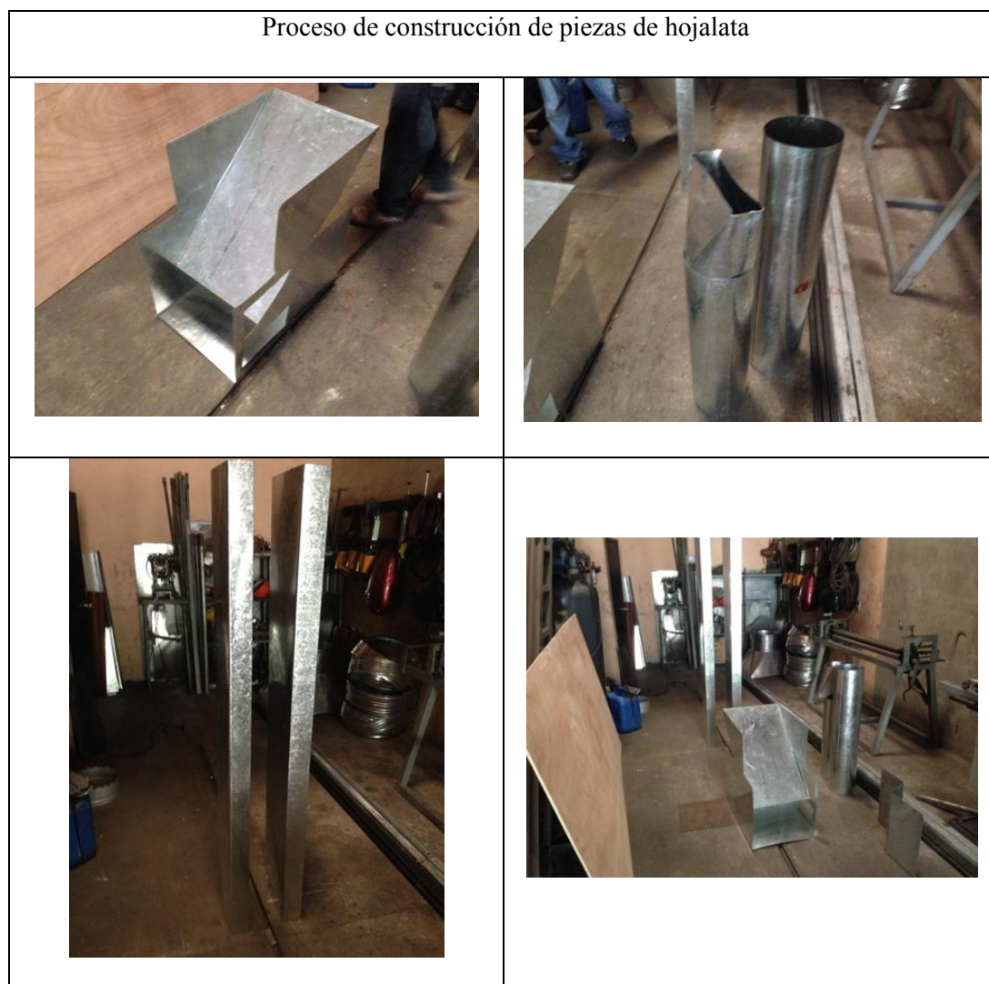
Figura 34. Proceso de construcción de piezas de hojalata
