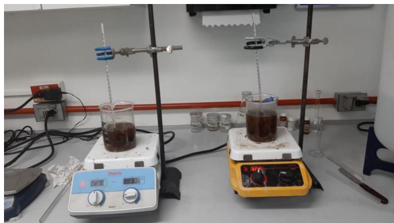
Figura 38. Sistema de extracción de una sola etapa para solución de etanol y agua destilada con pulpa de café.
