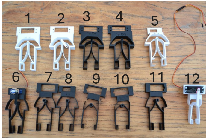
Figura 22. Prueba de pinzas flexibles con diferentes parámetros
