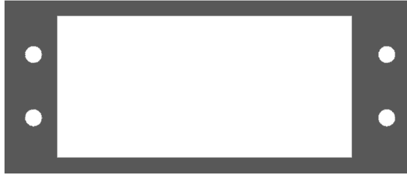
Figura 40. Agujeros de ajuste para servomotor dentro del eslabón base.
