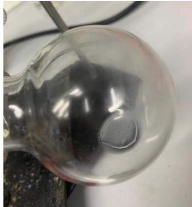
Figura 23. Producto de la destilación por arrastre de vapor para la extracción del aceite esencial de cáscaras de mandarina
