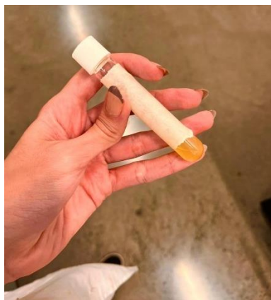
Figura 32. Muestra enviada para el análisis por HPLC de la producción de etanol a partir de la fermentación de cáscaras de mandarina y toronja
