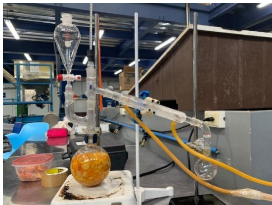
Figura 24. Sistema de destilación por arrastre de vapor para la extracción del aceite esencial de cáscaras de toronja
