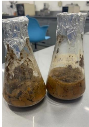
Figura 27. Producto de la hidrólisis ácida con ácido sulfúrico 5% de cáscaras de toronja
