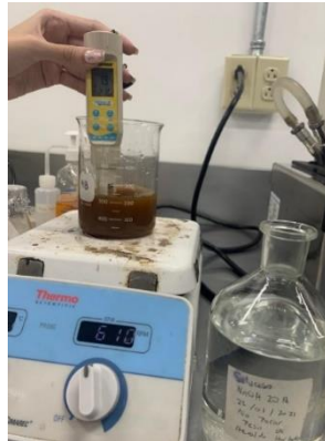
Figura 28. Ajuste de pH con hidróxido de sodio 5% a los mostos obtenidos tras la hidrólisis ácida de cáscaras de mandarina y toronja
