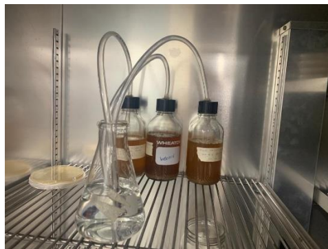
Figura 29. Sistema de fermentación con Saccharomyces cerevisiae de los mostos obtenidos tras la hidrólisis ácida de cáscaras de mandarina
