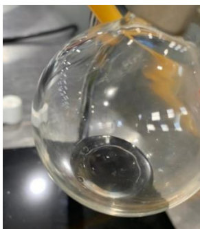
Figura 25. Producto de la destilación por arrastre de vapor para la extracción del aceite esencial de cáscaras de toronja
