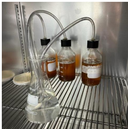
Figura 30. Sistema de fermentación con Saccharomyces cerevisiae de los mostos obtenidos tras la hidrólisis ácida de cáscaras de toronja
