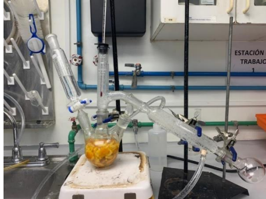
Figura 22. Sistema de destilación por arrastre de vapor para la extracción del aceite esencial de cáscaras de mandarina
