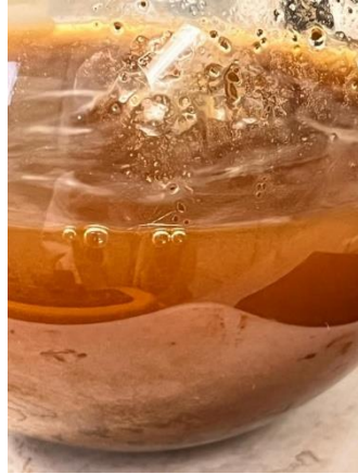
Figura 33. Destilación simple del mosto fermentado de cáscaras de mandarina y toronja para la extracción de etanol
