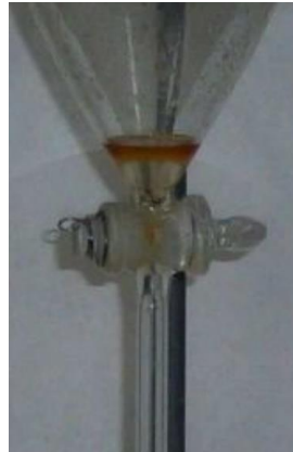
Figura 48. Separación del aceite esencial en un embudo de decantación
