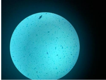
Figura 36. Cuantificación de las levaduras al final de la fermentación a través de la cámara de Neubauer
