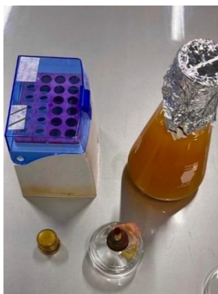
Figura 31. Toma de muestras para el análisis por HPLC de la producción de etanol a partir de la fermentación de cáscaras de mandarina y toronja
