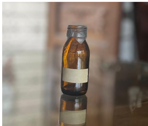
Figura 38. Aceite esencial de toronja obtenido tras la extracción por una destilación por arrastre de vapor
