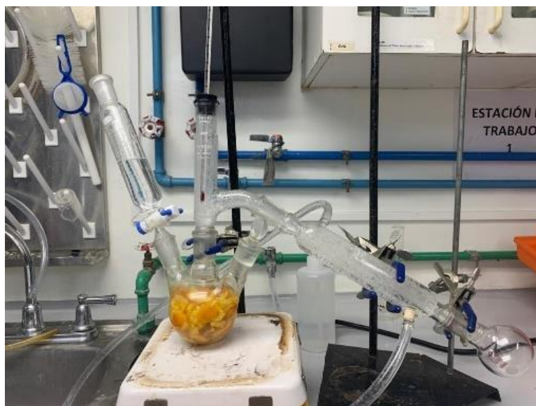
Figura 8. Sistema de destilación simple
