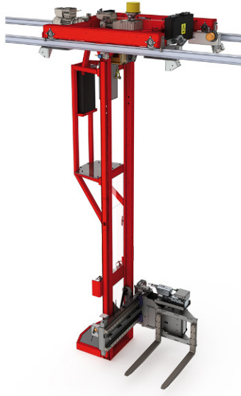
Figura 10: Transelevador Trilateral - Hubmaster
