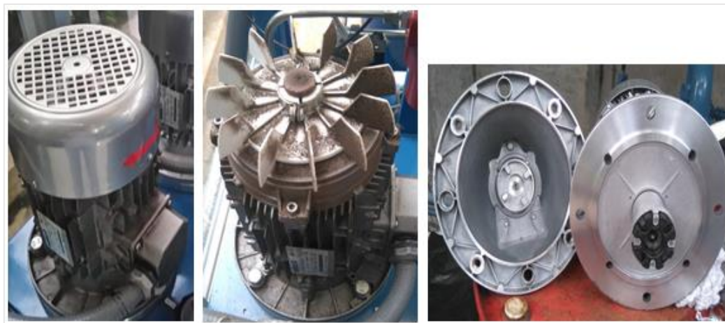
Figura 26. Motor de bomba de engranajes de la unidad de presión hidráulica.
