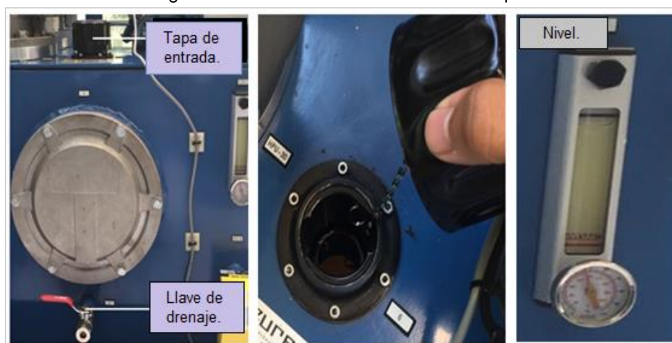
Figura 27. Nivelación de lubricante del tanque HPU.
