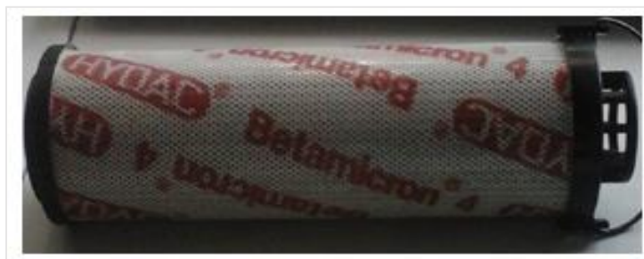
Figura 31. Elemento filtrante del dispositivo de retorno de la unidad de presión hidráulica.
