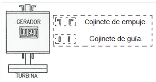
Figura 12. Esquema de posición de cojinetes del generador síncrono.
