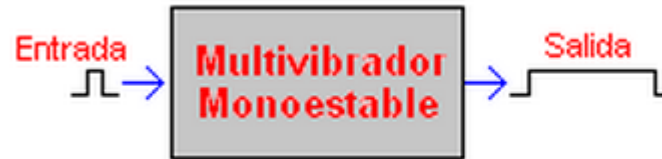
Figura 23. Representación de un multivibrador monoestable.
