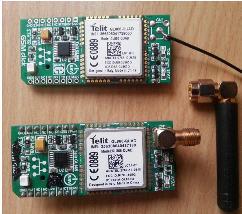
Figura 94. Módulos GSM, parte frontal con y sin modificaciones.
