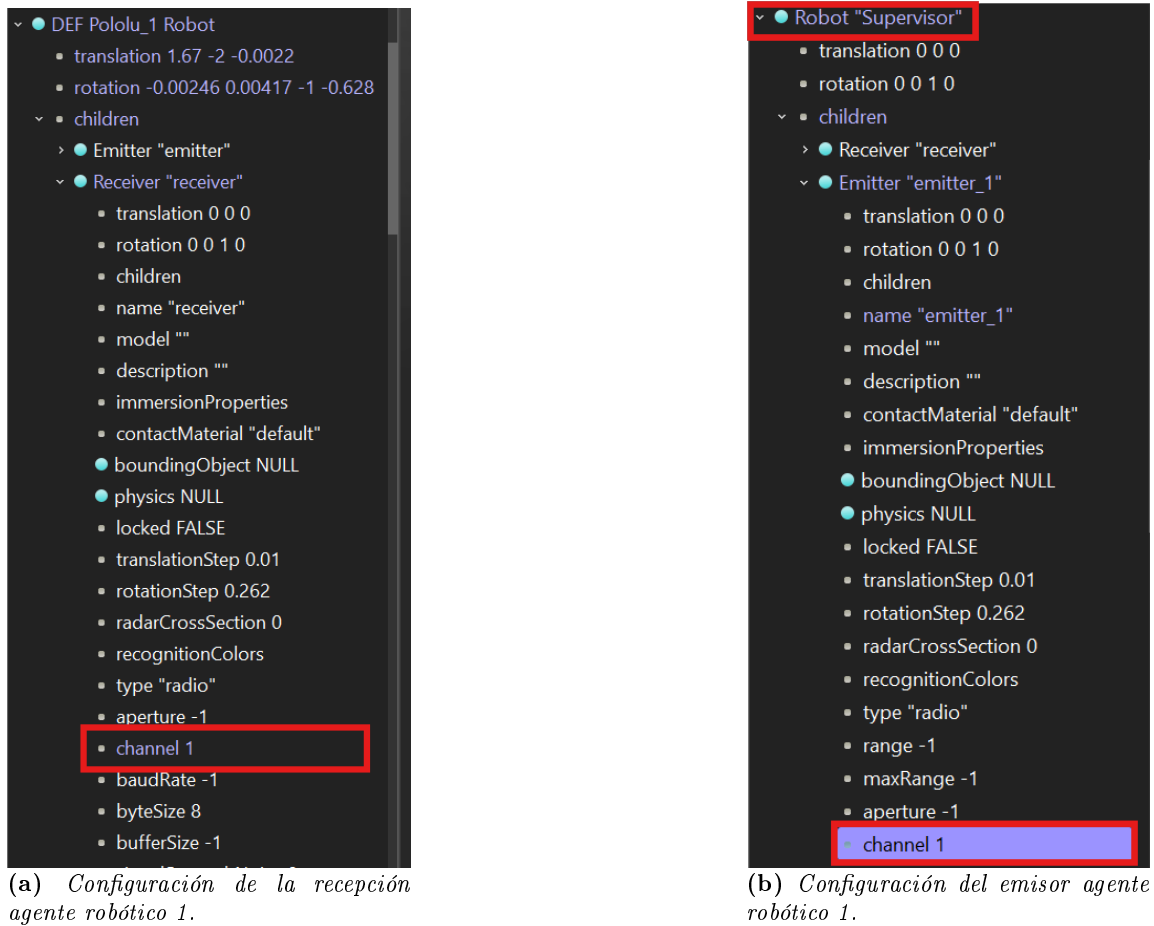
Figura 31: Configuración del emisor y receptor en Webots.
