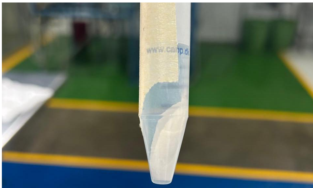
Figura 34. Resultado de la centrifugación del TPA para remover la fase líquida ácida
