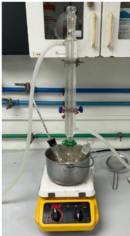
Figura 7. Sistema utilizado para la hidrólisis alcalina de PET
