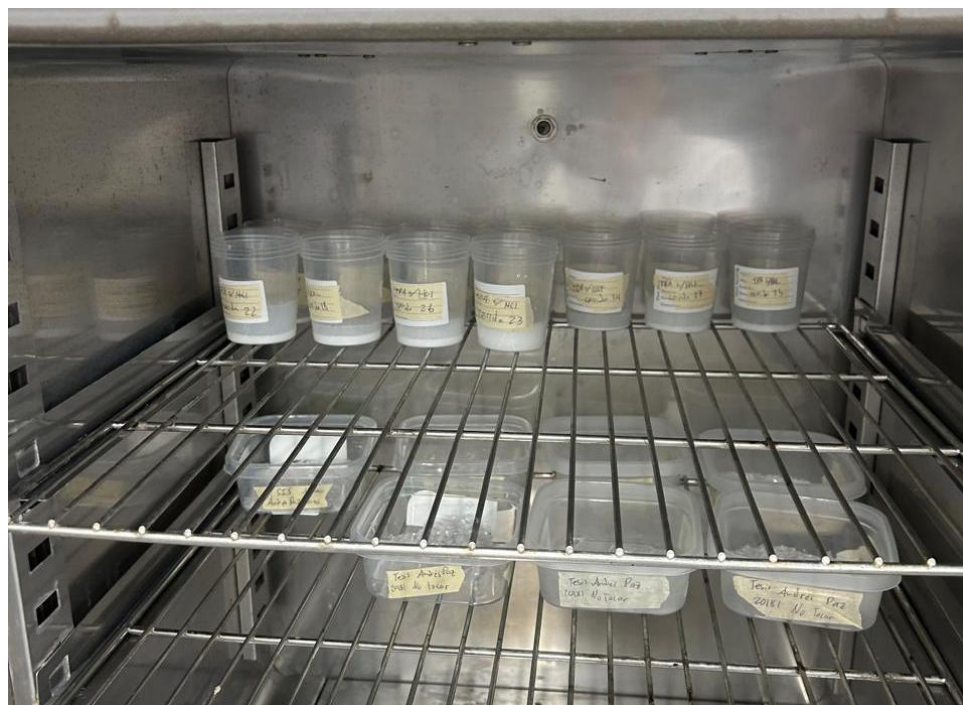
Figura 35. Secado de muestras de TPA y PET sólido sin reaccionar
