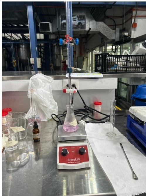
Figura 8. Sistema para la titulación del TPA resultante
