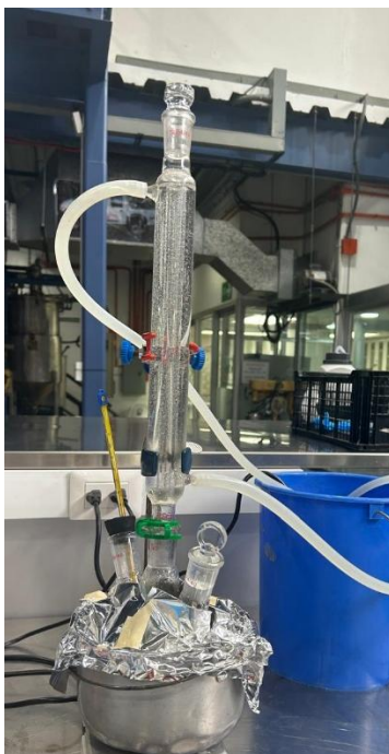
Figura 28. Sistema empleado para llevar a cabo al reacción a tiempos prolongados
